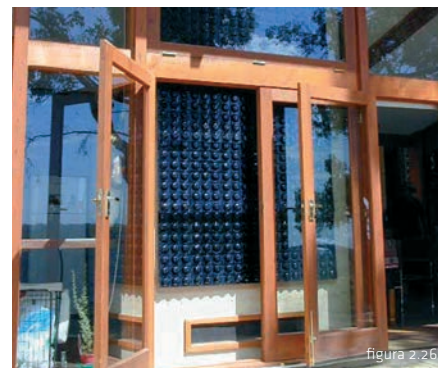
Fig. 2.25. Residencial Jaraguá. Jaraguá. Brasil. Paulo Mendes da Rocha. 1984 Fig. 2.26. Estrategia de precalentamiento del aire. Muro trombe ventilado. Australia
