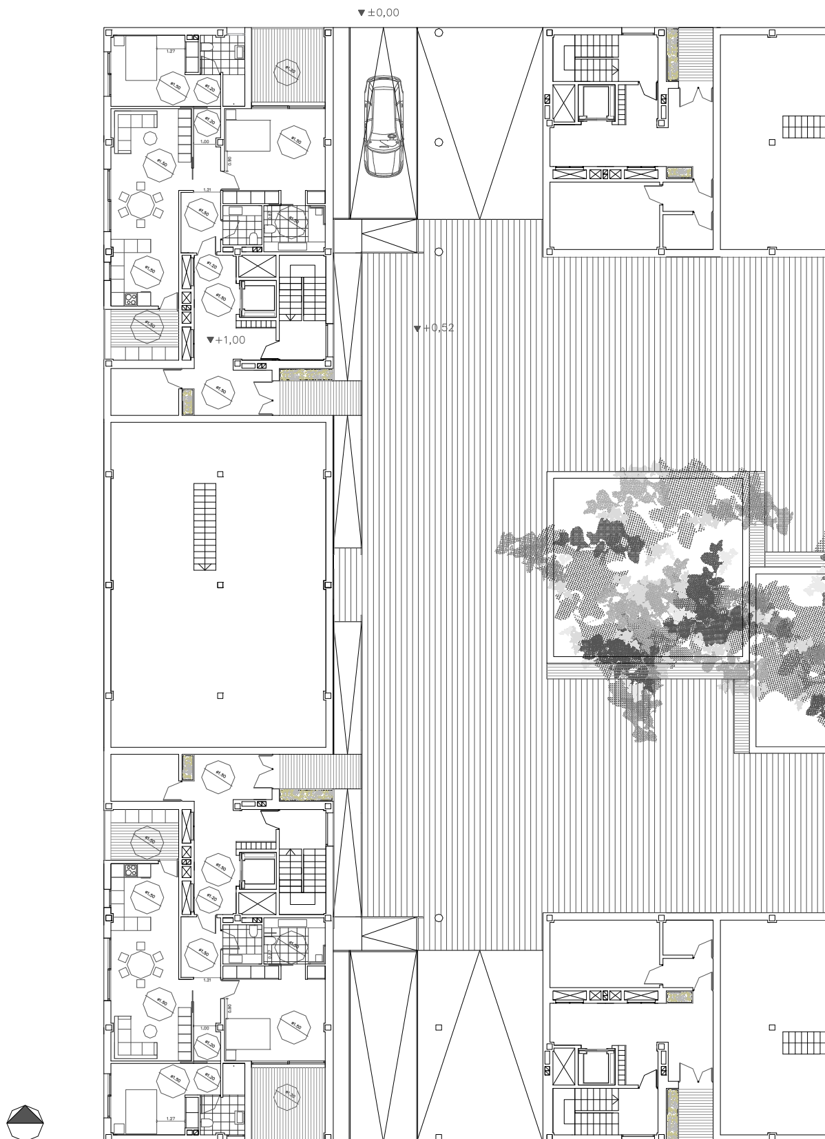
Planta acceso: P02.Local comercial y P03 Viviendas accesibles y accesos a edificio.
