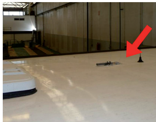
Figura 4. Ubicación de la sonda de CO 2 del primer prototipo en el techo del autobús urbano.
