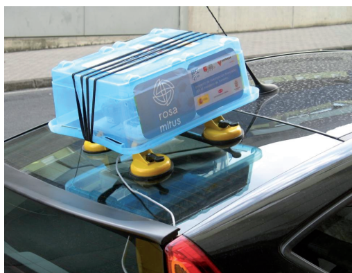
Figura 8. Prototipo multisensor instalado en un vehículo privado para pruebas
