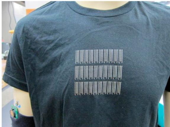
Camiseta con electrodos que detectan la temperatura corporal. *Project ATTACH, University of California-San Diego*
