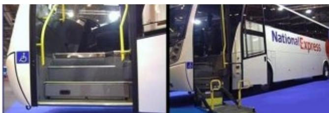
**Acceso para sillas de ruedas en un autobús de piso semi-bajo o elevado, mediante plataforma elevadora que se escamotea en los escalones de acceso**
