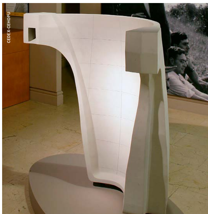
Modelo de ensayo de la presa de Quentar (Granada) del ingeniero Carlos Fernández Casado. Escala: 1:50. Archivo Carlos Fernández Casado.
