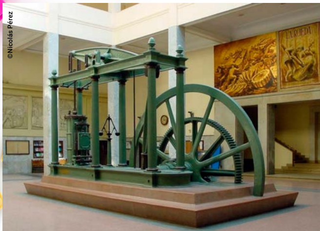
Maqueta de una máquina de vapor de tipo Watt, construida por D. Napier and Son (Londres) en 1859.
