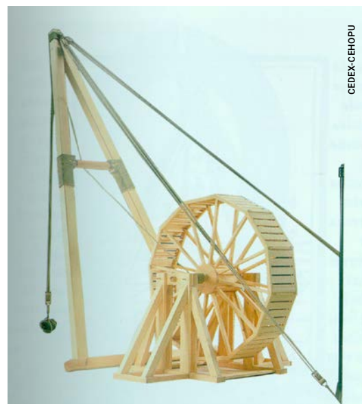
Maqueta de una grúa movida con rueda de pisar de la época romana. Medidas: 250 x 150 cm. Escala: 1:5.
