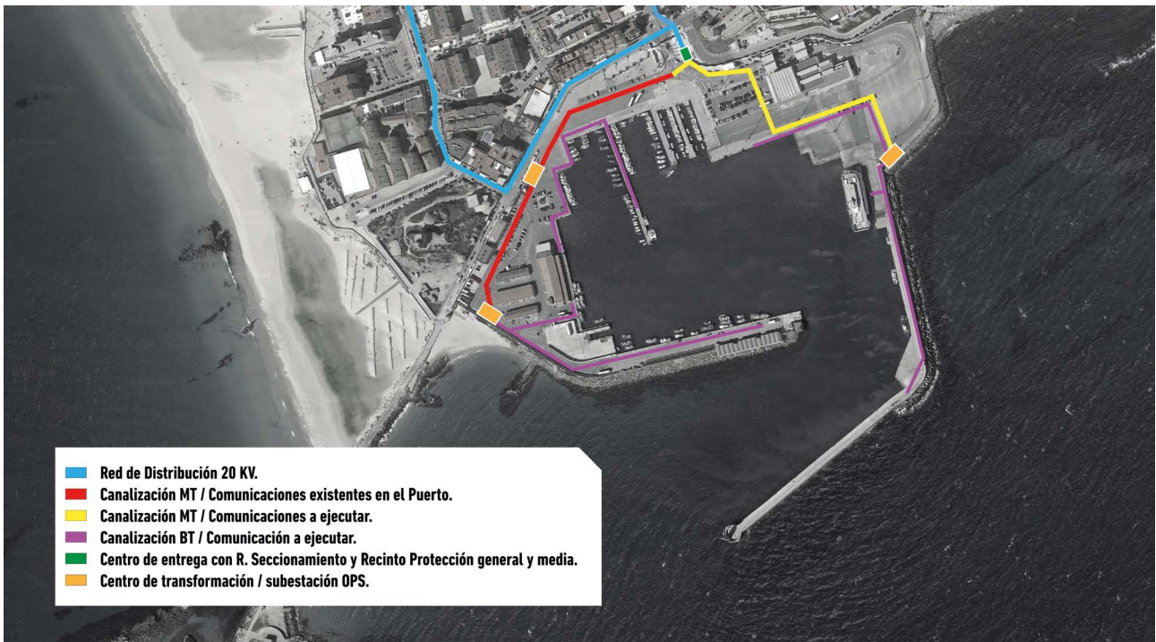
Conexión a la red eléctrica de distribución para OPS del Puerto de Tarifa. Fuente: Autoridad Portuaria de la Bahía de Algeciras.
