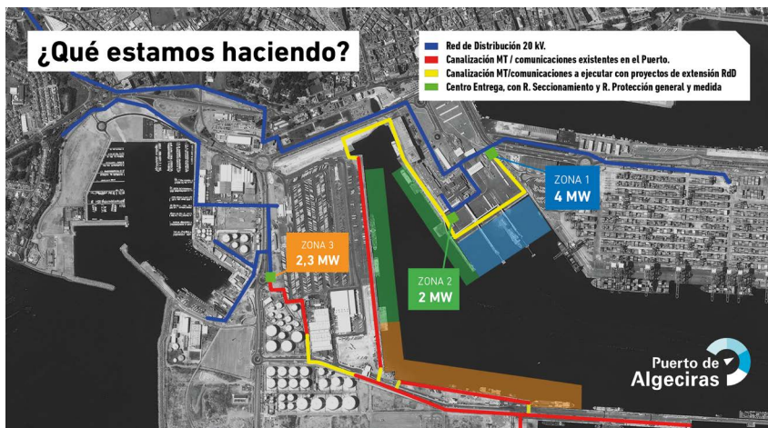
Conexión a la red de distribución para OPS de la Dársena de la Galera: Zonas 1 a 3. Fuente: Autoridad Portuaria de la Bahía de Algeciras.
