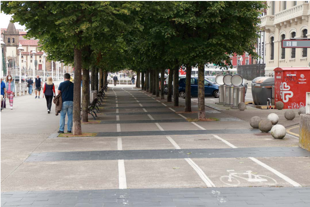
Fotografía 6.25 Pavimento mixto hormigón / adoquines de piedra natural
