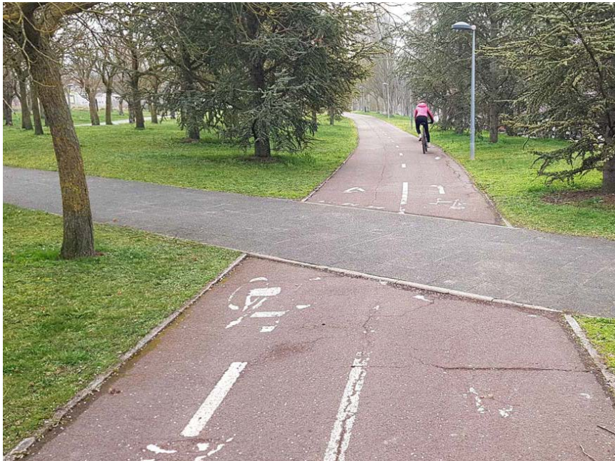
Fotografía 5.6 Ceda de paso en vías ciclistas que cruzan senderos. Izquierda, con continuidad del pavimento del sendero. Derecha, con paso de peatones
