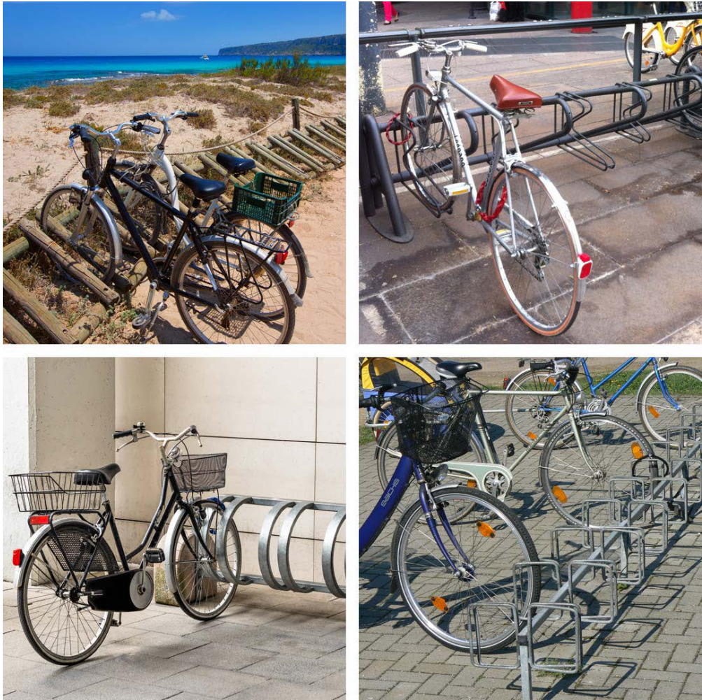
Fotografía 7.9 Aparcamientos de soporte de rueda
