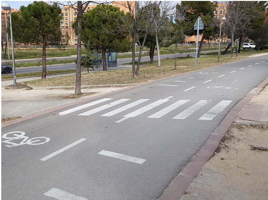
Fotografía 5.6 Ceda de paso en vías ciclistas que cruzan senderos. Izquierda, con continuidad del pavimento del sendero. Derecha, con paso de peatones
