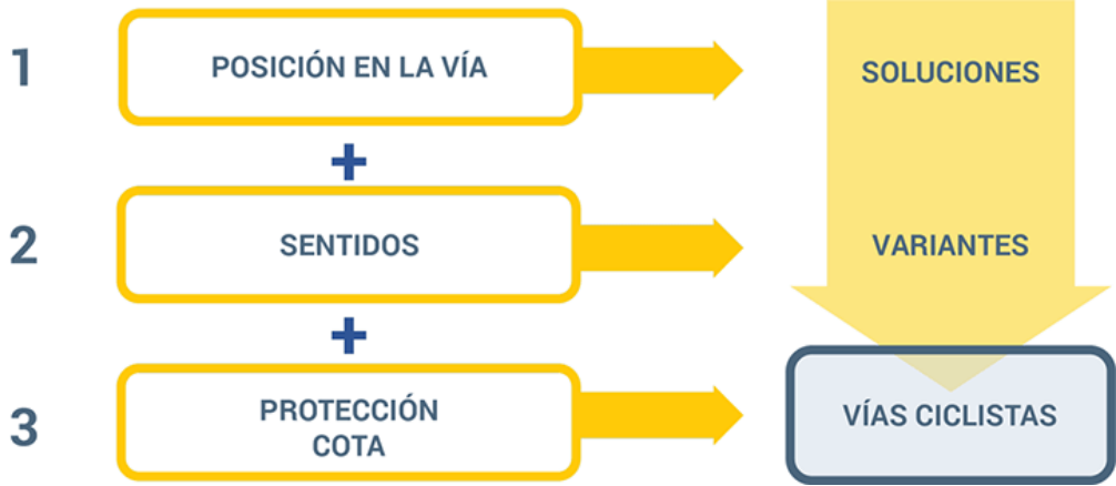
Figura 4.9 Esquema de la metodología de definición de una vía ciclista como opción de diseño
