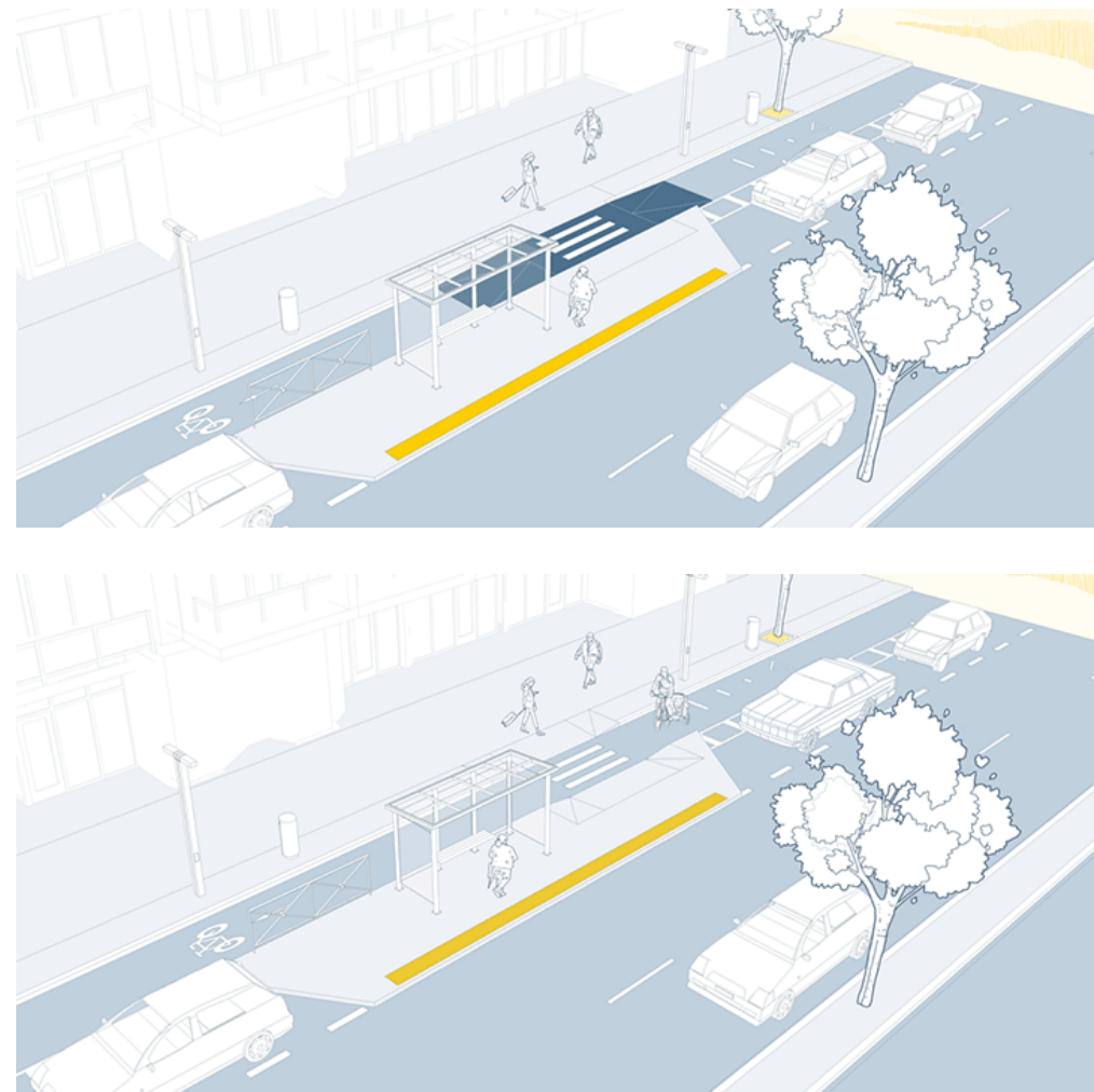
Figura 5.54 Esquemas de parada con vía ciclista por detrás de la parada con elevación de la vía ciclista y con barbacana para el cruce peatonal
