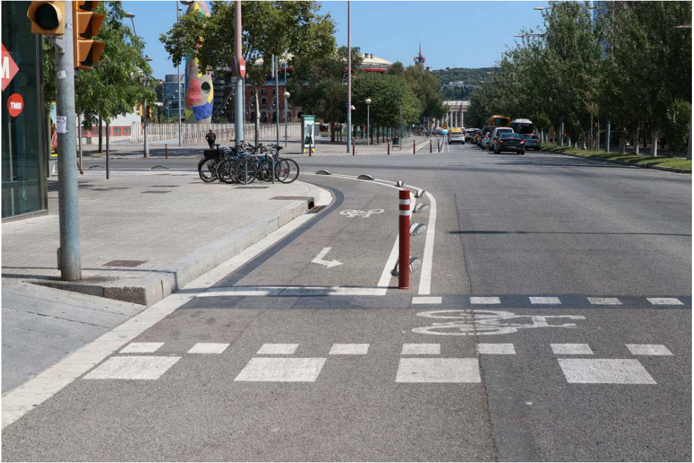
Fotografía 3.8 Mantenimiento del resguardo ante baliza puntual h > 15 cm (bolardo)
