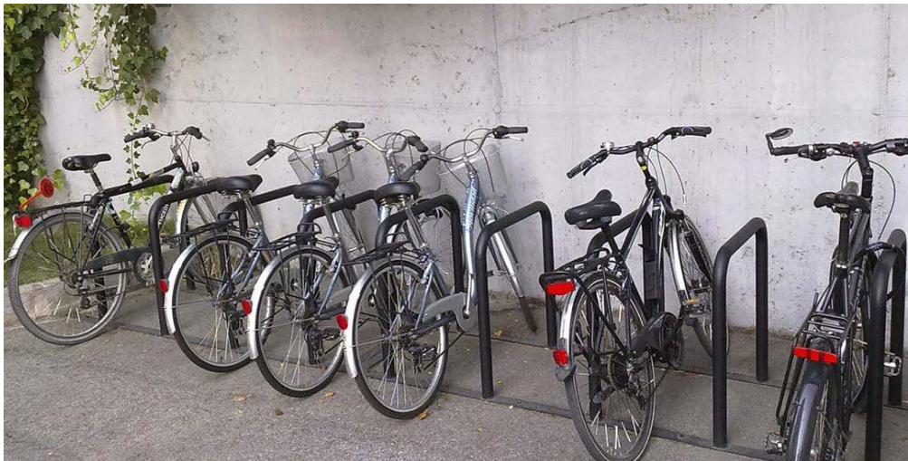
Fotografía 7.6 Aparcabicis U invertida (con anclaje de barra transversal)
