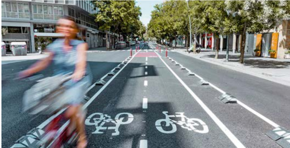
Fotografía 4.17 Vía ciclista bidireccional en el centro de la calzada con protección ligera
