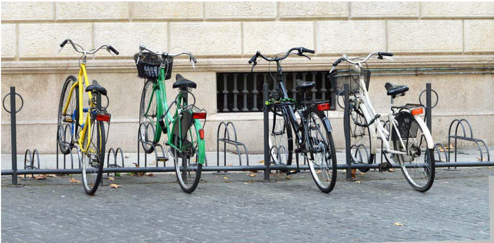
Fotografía 7.10 Aparcabicis de rueda alto-bajo con y sin poste de fijación central
