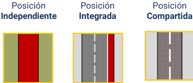
Figura 4.4 Posición: ubicación de la solución ciclista respecto del soporte sobre el que se implanta
