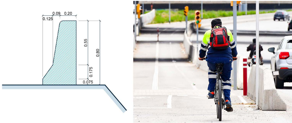
Fotografía 6.47 Barrera fija prefabricada de hormigón
