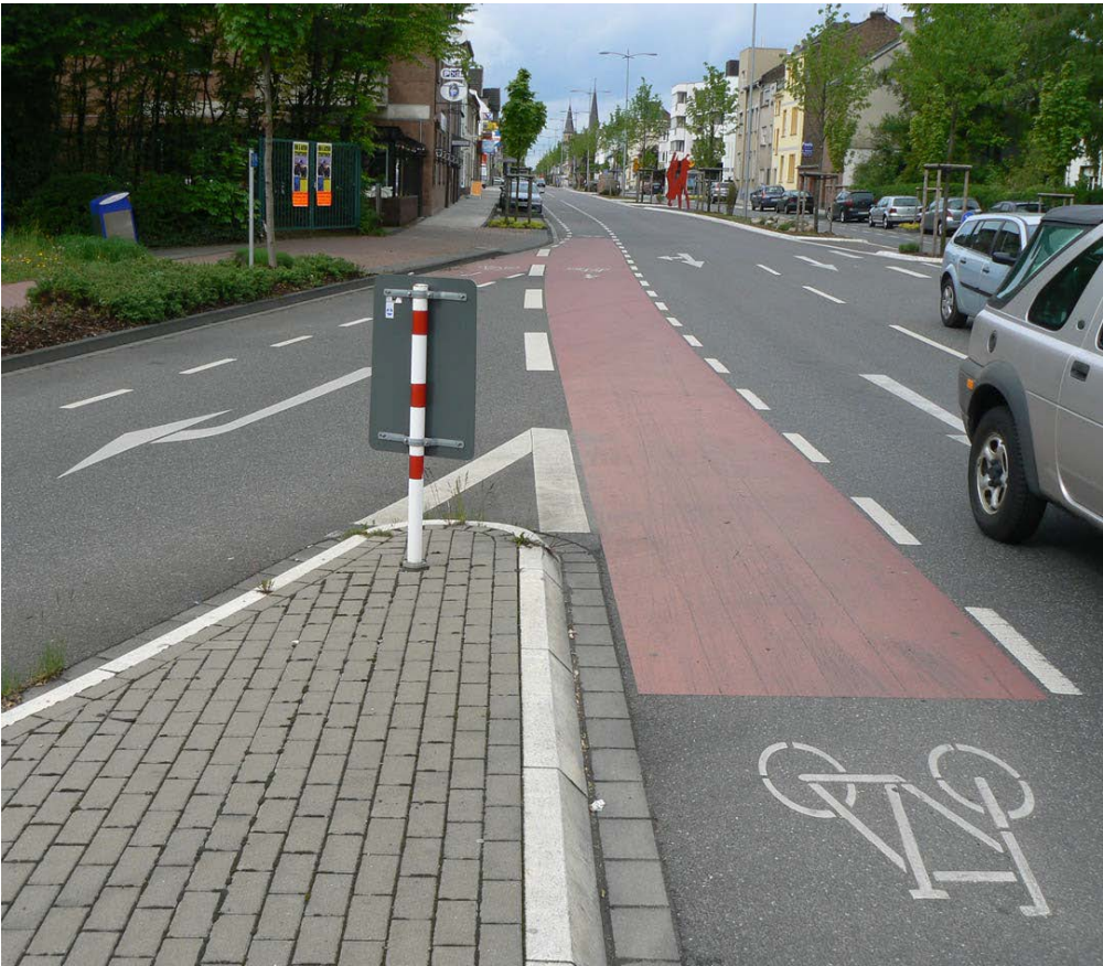
Fotografía 5.17 Trazado directo de carril unidireccional
