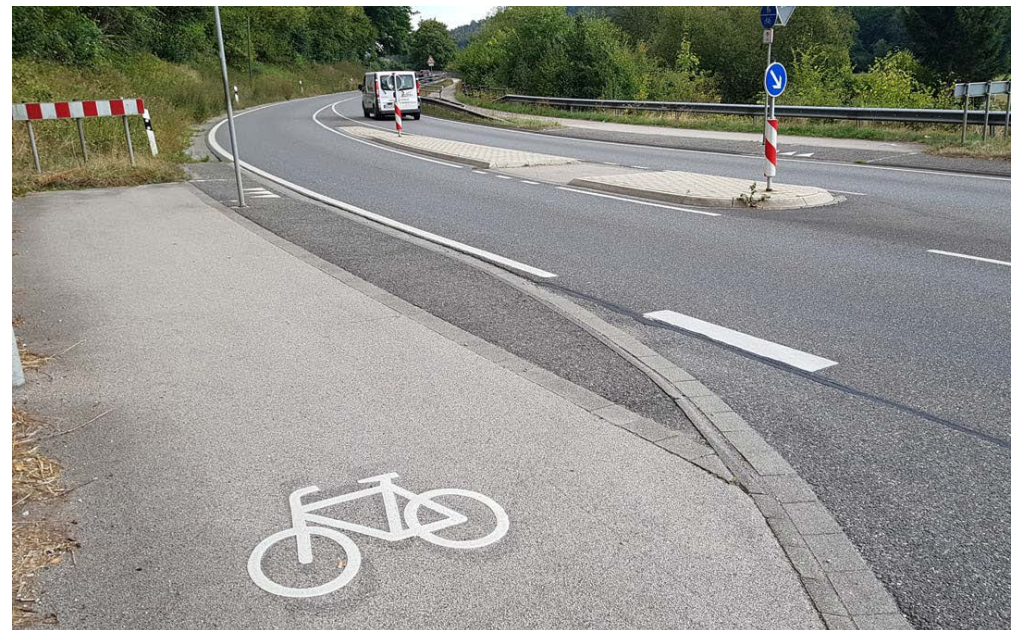
Fotografía 5.18 Trazado directo de carril unidireccional
