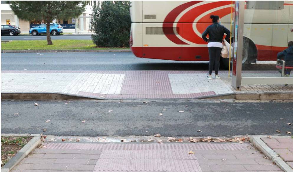
Fotografía 5.26 Paso rebajado y paso elevado para cruzar vía ciclista de acera a banda de servicio
