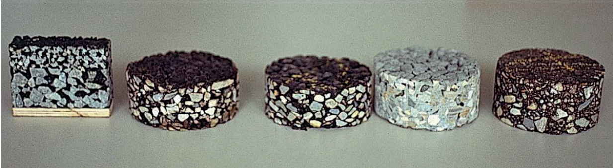
Figura 19: Muestras de núcleos de superficies de rodadura. De izquierda a derecha: capas gemelas de asfalto poroso con revestimiento de caucho, capa única de asfalto poroso con revestimiento de caucho, monocapa poroso asfalto, hormigón poroso, asfalto denso.
