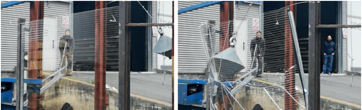
Figura 56: Imágenes de un ensayo de riesgo de caída de trozos desprendidos sobre pantalla de metacrilato reforzado.
