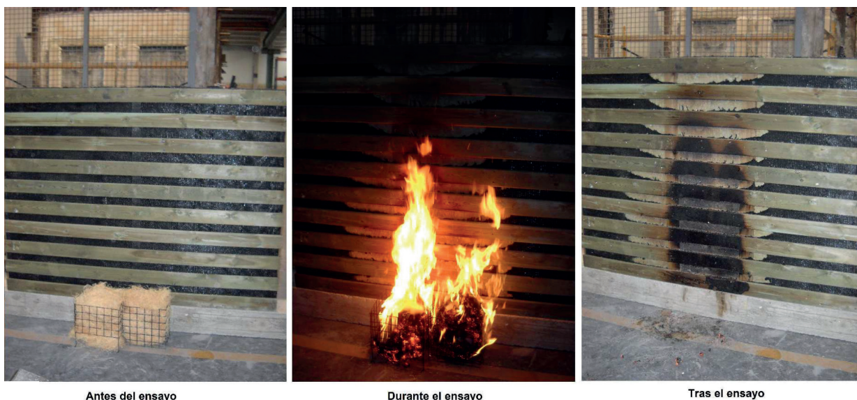
Figura 58: Detalle del proceso de ensayo de fuego de una pantalla acústica de madera.
