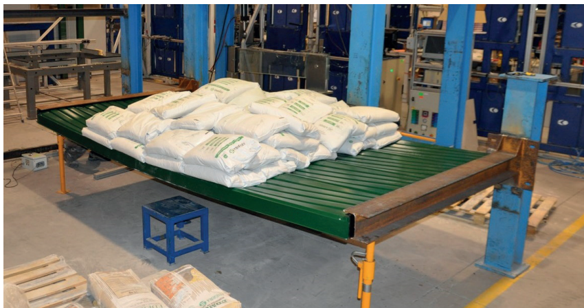
Figura 57: Imagen del ensayo de carga de nieve de una pantalla acústica metálica.
