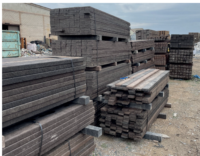
Figura 21: Lamas de madera obtenidas a partir de la materia prima de plásticos no reciclables.
