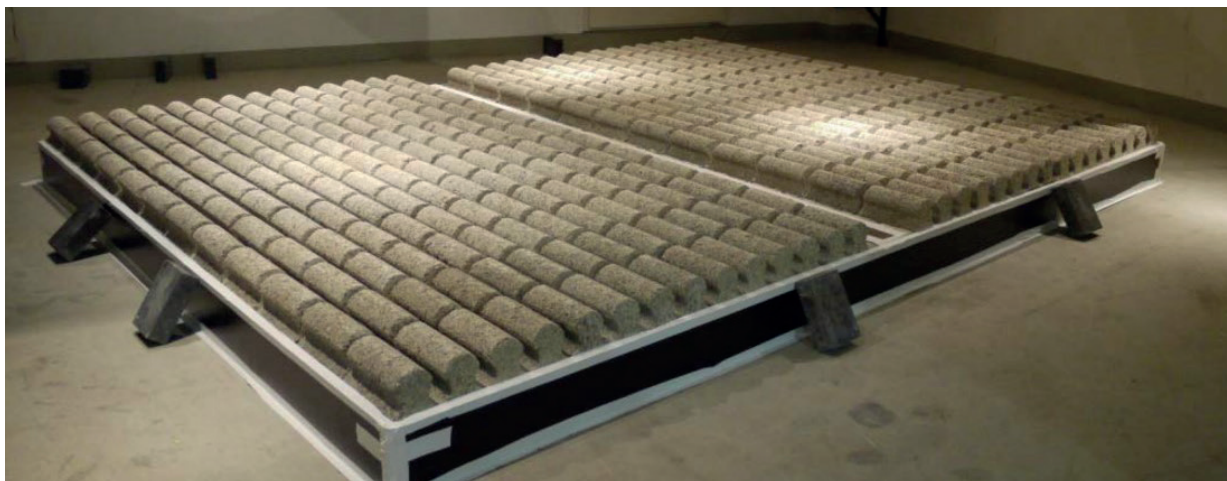
Figura 51. Disposición en laboratorio para ensayo de la absorción acústica.
