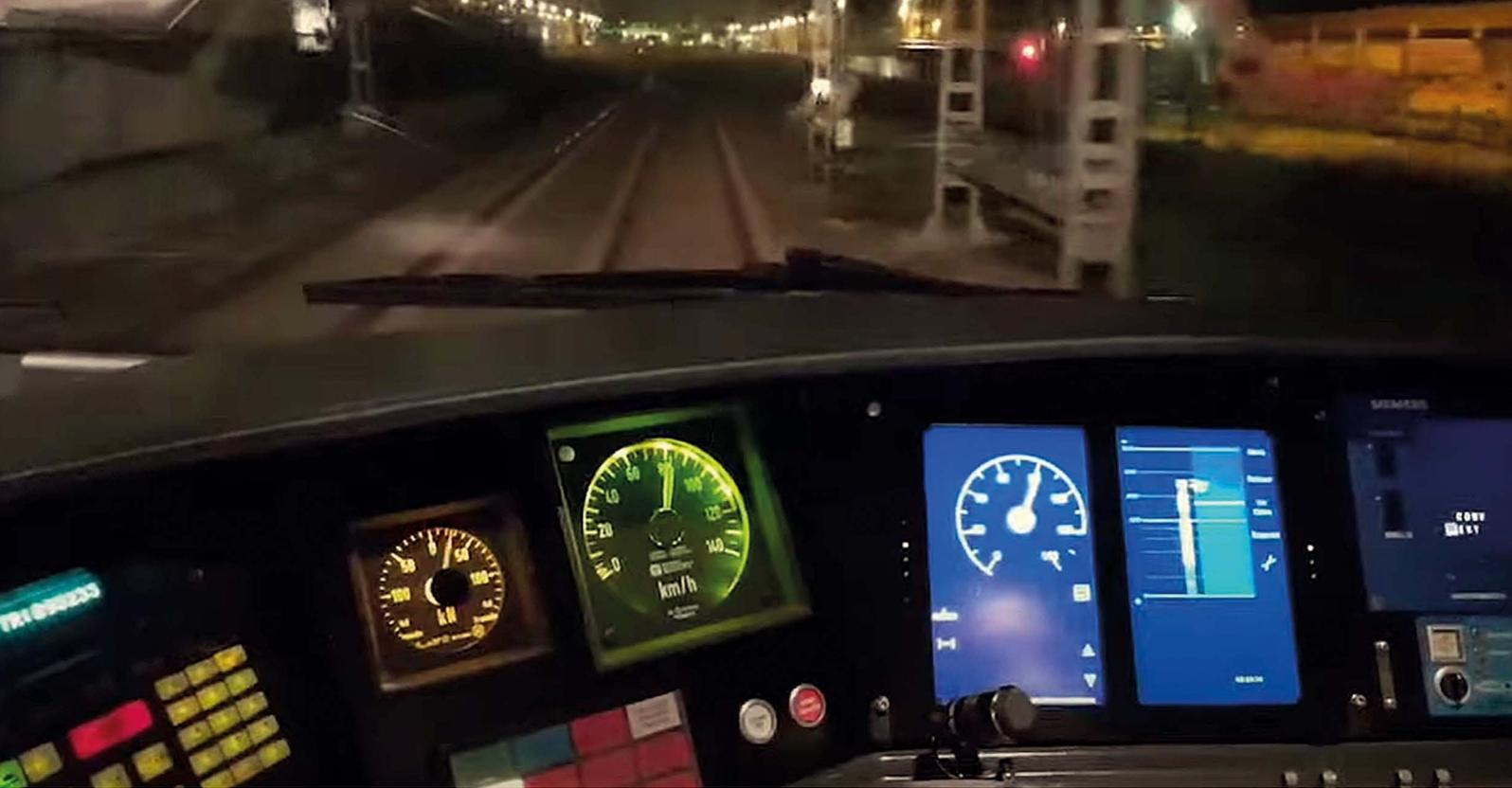
ERTMS a bordo: detalle de la interfaz de la cabina de conducción
