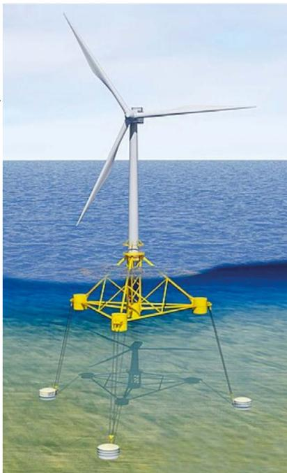
Diagrama del sistema de posicionamiento de un aerogenerador flotante.
