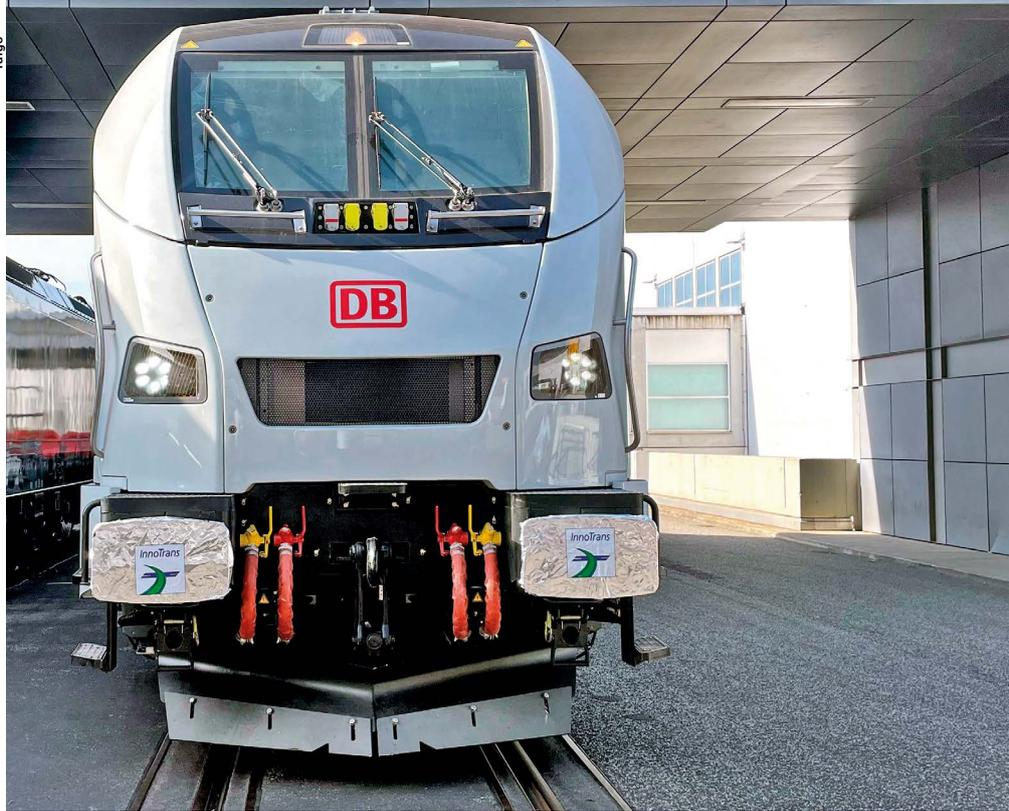
Frontal de la locomotora Baureihe 105 para el operador germano DB.
