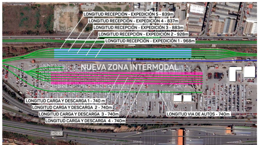
Infografía del estado final del nodo de Barcelona-La Llagosta.
