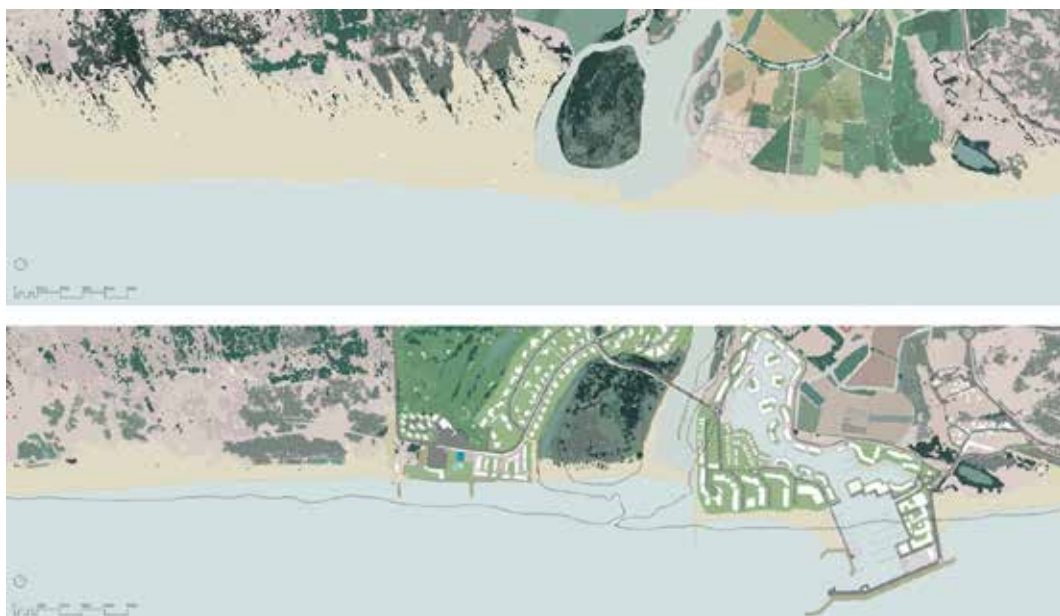
FIG. 10 / Pérdida de la línea de costa (más de 150m), en playa y desembocadura del río Guadiaro entre 1956 (arriba) y 2020 (abajo), por la construcción del puerto deportivo de Sotogrande (Cádiz)
