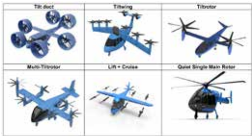
FIG. 1 / Tipología de vehículos aéreos VTOL (Vertical Take-Off and Landing [prototipos]), todos los de la figura pueden transportar hasta un máximo de seis pasajeros (por ejemplo, en servicios de taxi aéreo)
