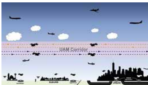
FIG. 2 / Utilización del espacio aéreo por los vehículos VTOL (Vertical Take-Off and Landing), ejemplo de corredor aéreo UAM (Movilidad Aérea Urbana) de varias pistas
