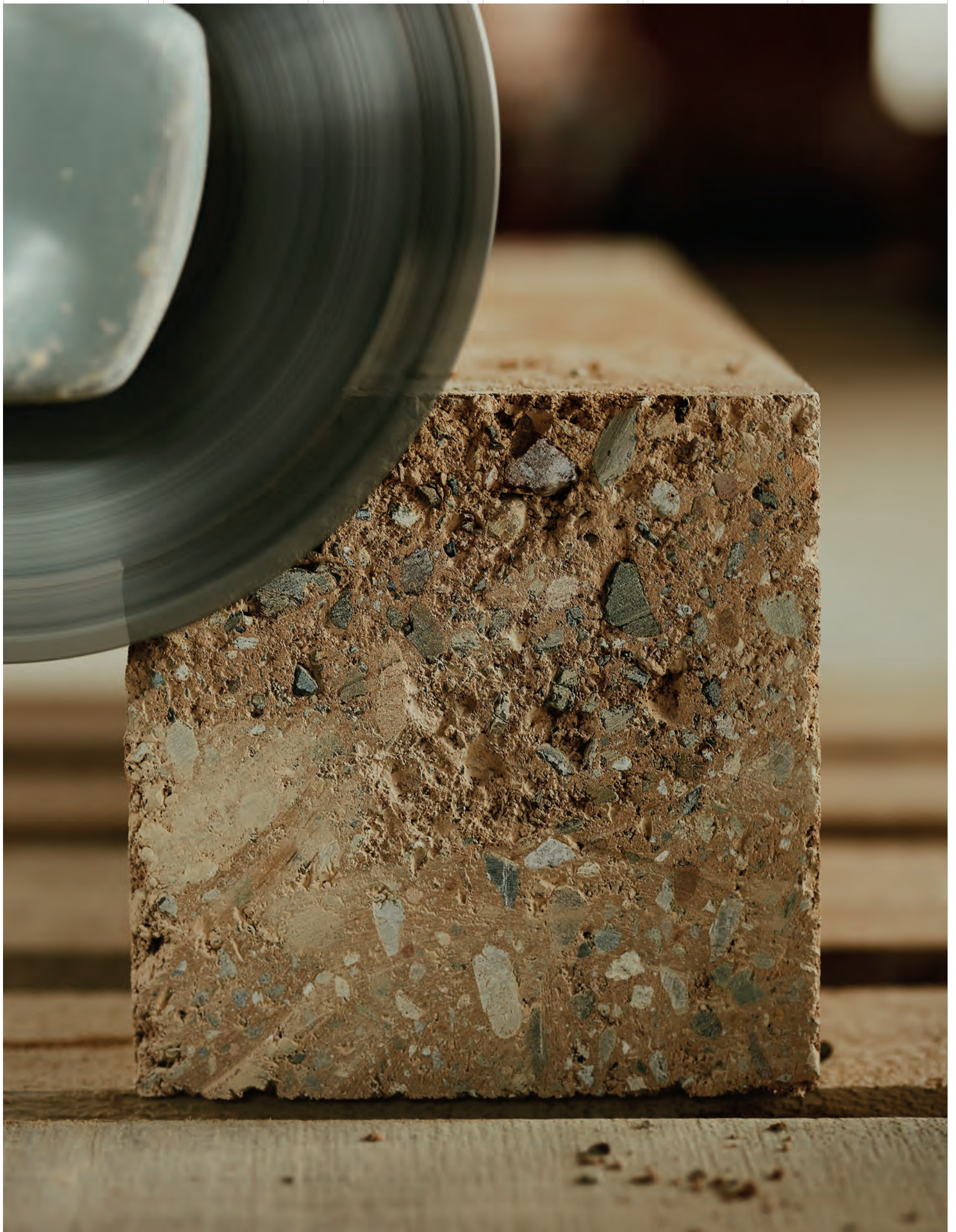
Corte manual de una pieza prefabricada de tierra compactada de Fetdeterra. Foto: Caterina Barjau / Manual cutting of a prefabricated rammed earth block by Fetdeterra. Photo: Caterina Barjau
