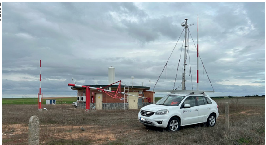
Calibración de sistema de radionavegación aérea VOR.
