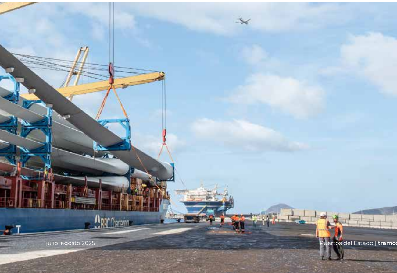
Operativa de descarga de aerogeneradores en el Puerto de Granadilla.
