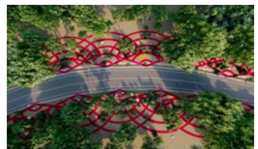
En las autovías A-4, A-32 y A-44 y en la carretera N-323 en las provincias de Jaén y Granada se ha apostado por vallados virtuales para impedir el acceso de los animales. Eulen.
