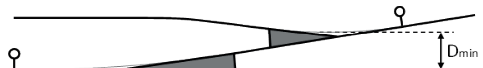
Figura 4.1.4.1.2. Distancia mínima entre el eje de la vía mango y la vía general
