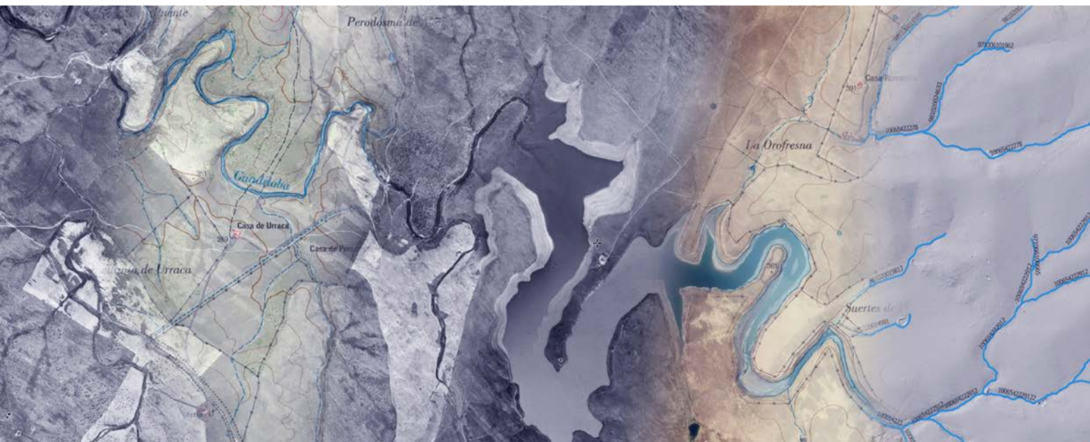
Ilustración evolutiva de los métodos de captura hidrográfica, desde minutas en campo hasta MDT LiDAR, pasando por fotointerpretación. Zona: embalse de Guadiloba.
