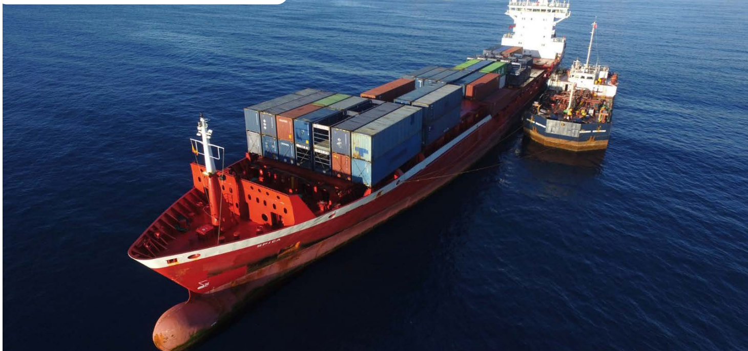
Maniobra de bunkering o suministro de combustible en Tenerife. Fuente: Autoridad Portuaria de Tenerife.
