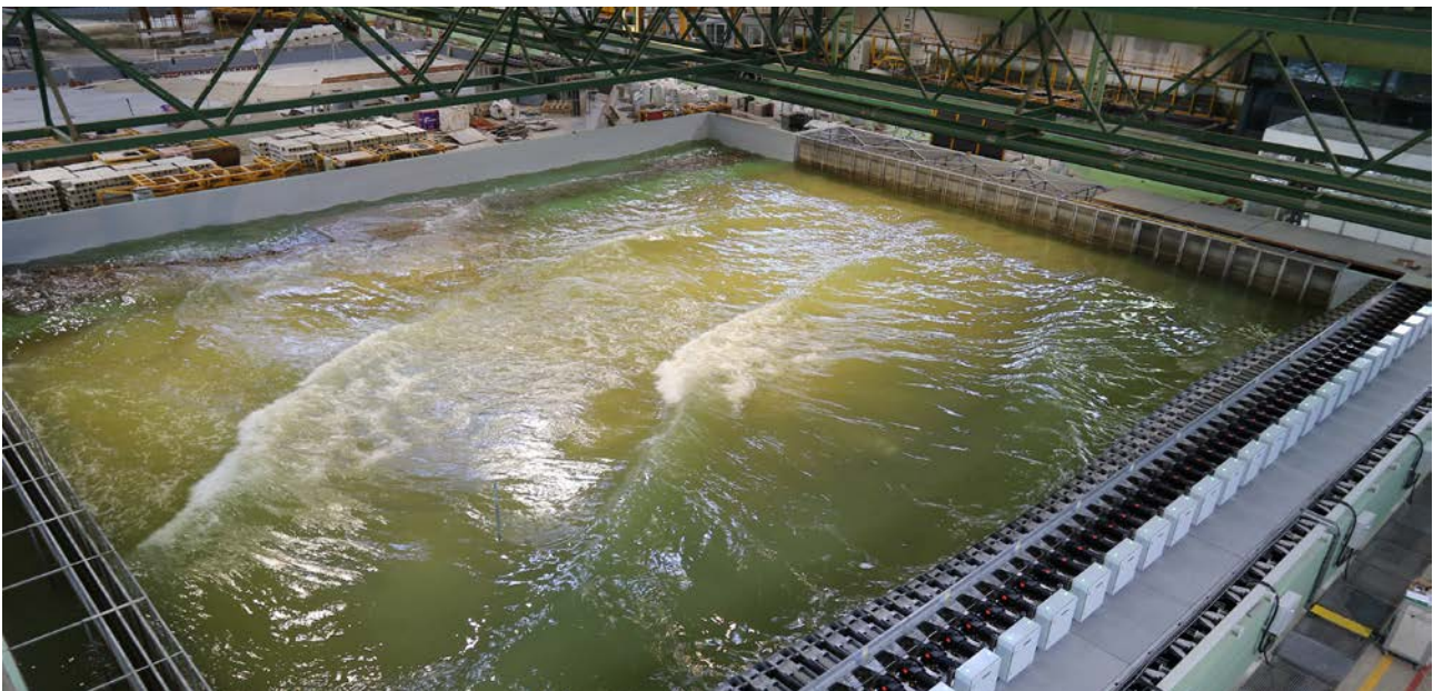
Tanque de oleaje multidireccional CEPYC. Felipe Martínez (PNIC 2022).
