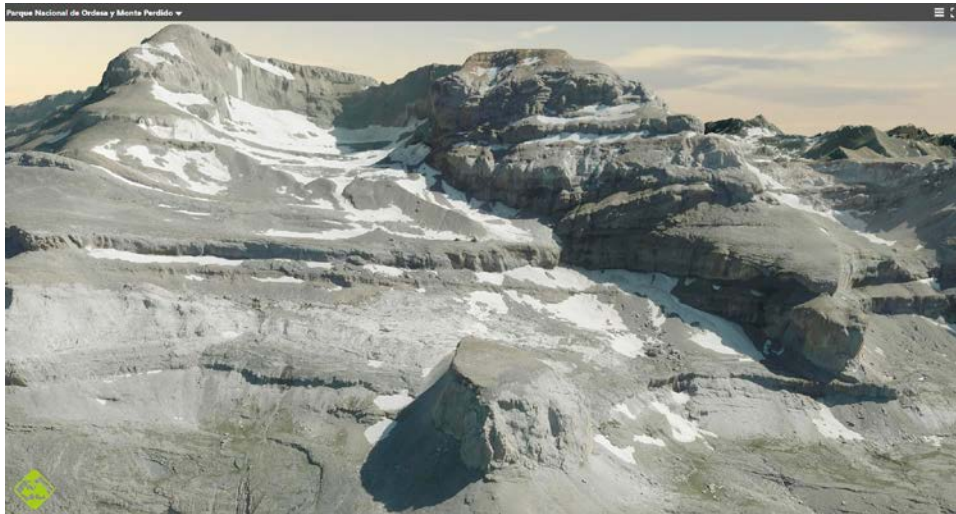
Modelo 3D realizado por correlación superdensa con fotografías aéreas. Web de 'Parques Nacionales Interactivos'.
