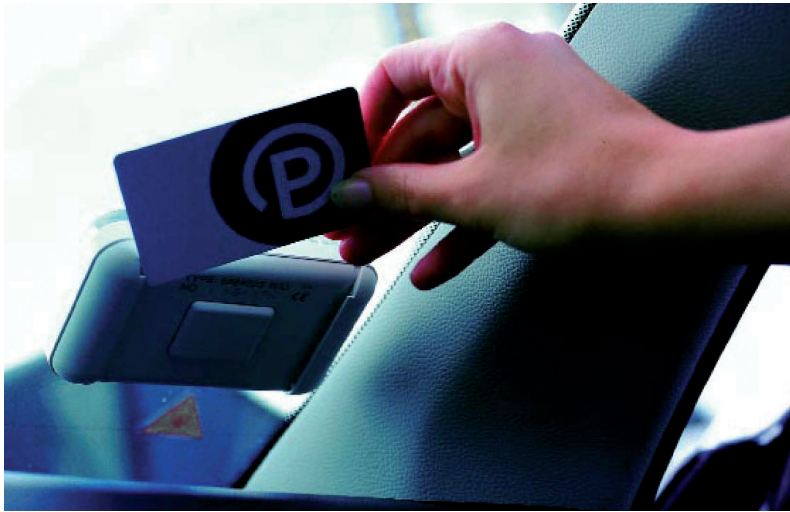
Lector de telepeaje instalado en el interior de un vehículo.
