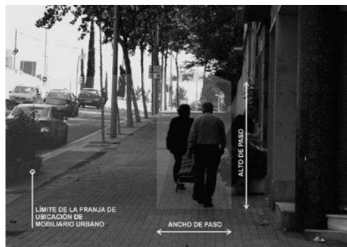
FIG. 1/ El túnel de circulación peatonal
