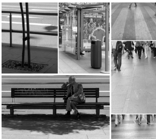
FIG. 6/ Dentro del modelo de urbanización propuesto destaca sobre todo el pavimento de granito de sus aceras siguiendo un modelo diferenciado entre las zonas de paso y las estanciales, quedando muy mermado con el paso del tiempo el mobiliario original propuesto, excepción hecha de las barandillas niqueladas para la contención del tráfico rodado
