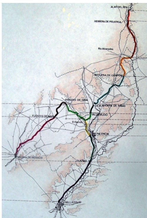
Fig. 3/ Tramos en la construcción del Canal de Castilla. Sólo entre Palencia y Valladolid (1802-1835) el Canal discurre paralelo al río y a los caminos, encajado en el valle
