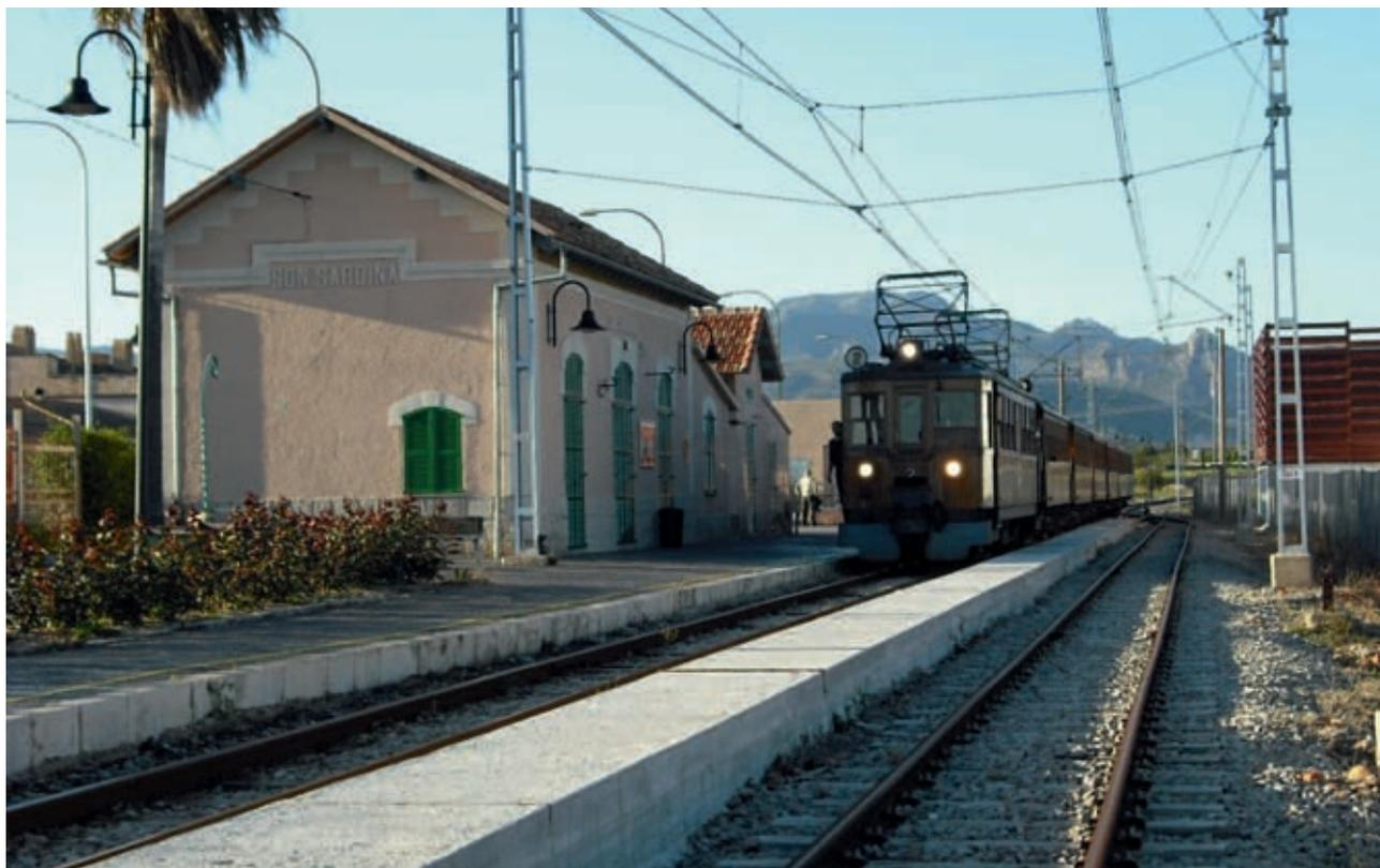
locomotoras de vapor y 14 vagones, se construyeron dos subestaciones eléctricas (Bunyola y Sóller) y se tendió la catenaria a lo largo de la línea, “a base de corriente continua de 1.200 voltios desde Palma a Sóller, y con tensión de 600 voltios desde este punto hasta el puerto”, según refiere el proyecto. El 14 de julio de 1929 se inició el nuevo servicio con tracción eléctrica, más fiable y capaz, con automotores y vagones construidos en madera de teca, los mismos existentes hoy en día.
