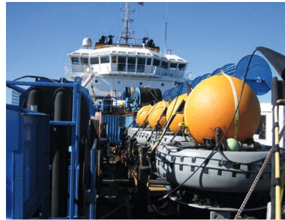
Traslado de instrumentación hidroacústica para su instalación en Wake Island (Océano Pacífico Norte).
