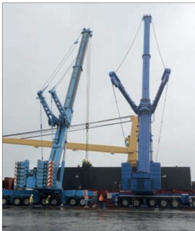
Traslado de las pontonas al buque mediante dos grúas móviles.
