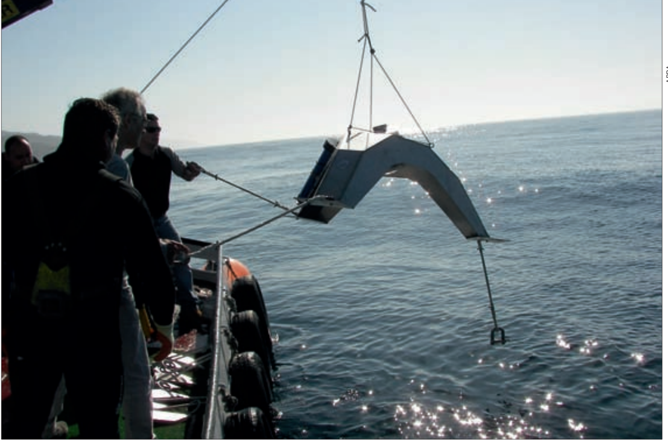
► Despliegue en aguas de la bahía de Algeciras de un correntímetro perfilador (ADCP), destinado a medir las corrientes marinas.
