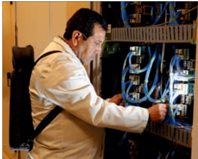
► Los trabajos en el correlador de ALMA, a 5.000 metros de altitud, se realizan con apoyo de oxígeno (instalado en la mochila).
