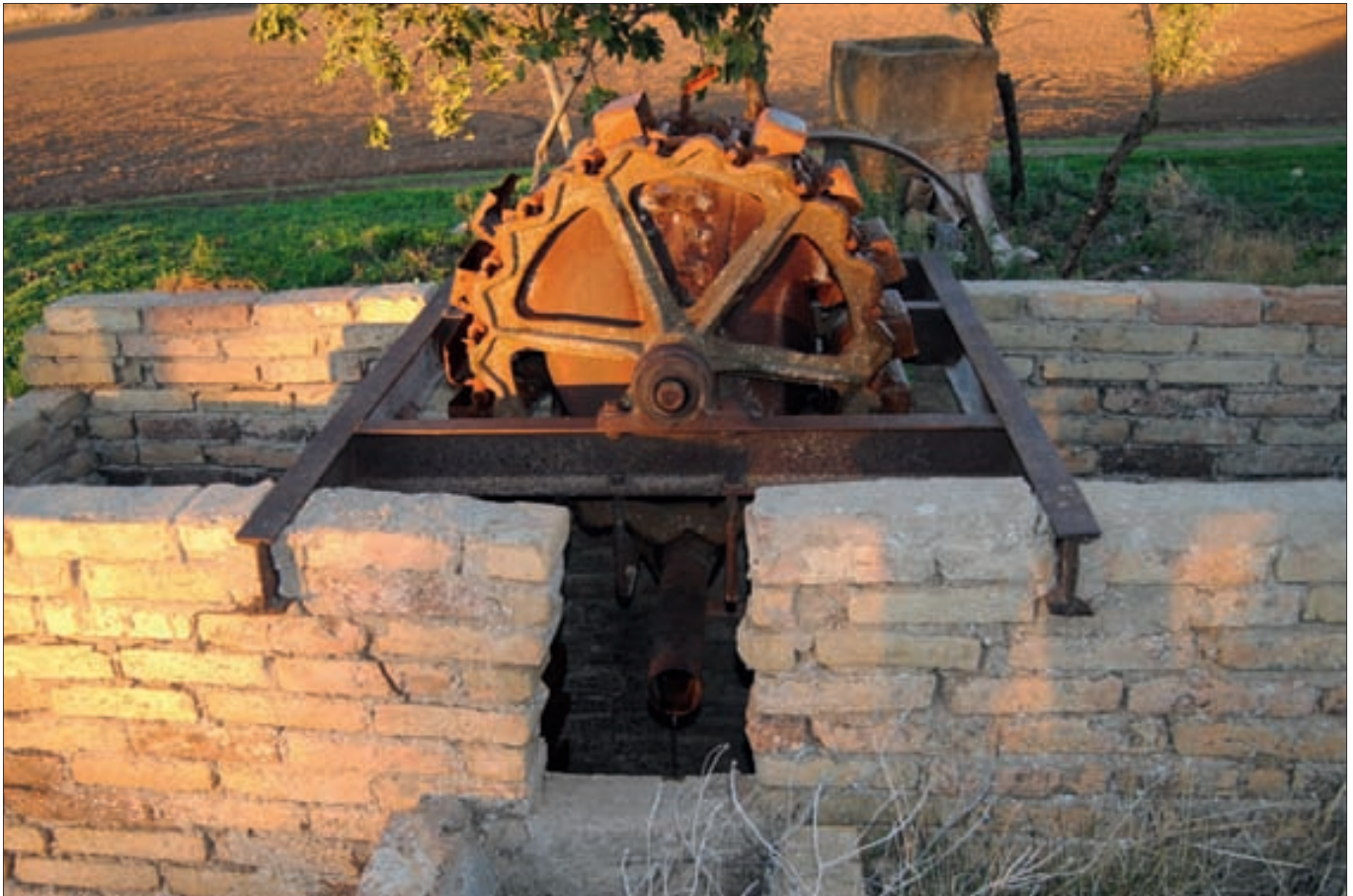
► Engranaje de una noria moderna, situada en las inmediaciones de la presa de Consuegra.
