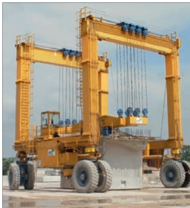
▶ Últimos retoques en el puente y grúa para el traslado de bloques.
