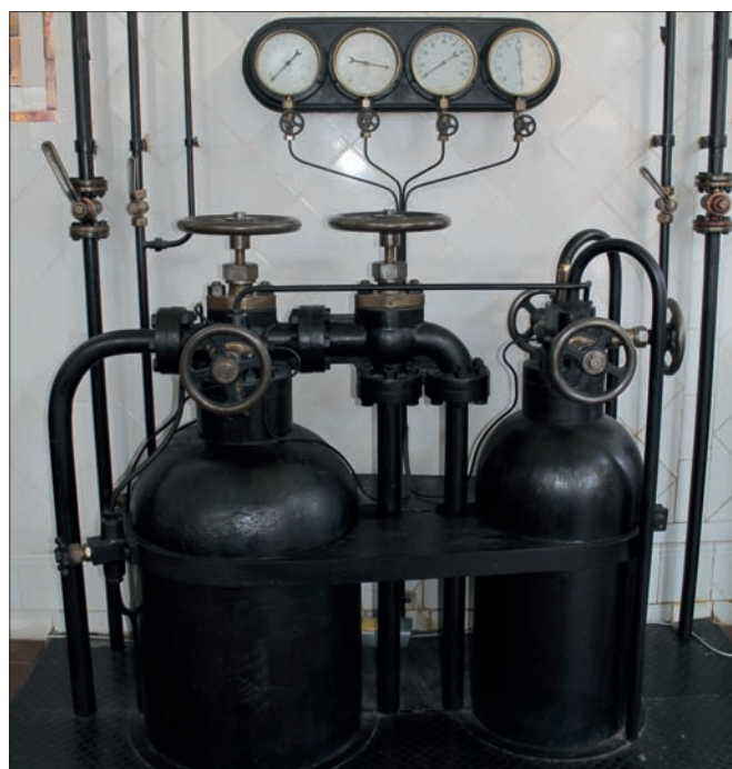
▶ Arriba, uno de los tres motores diésel de la nave. Debajo, botellas de aire comprimido para arrancar los motores y para el aire de inyección.
