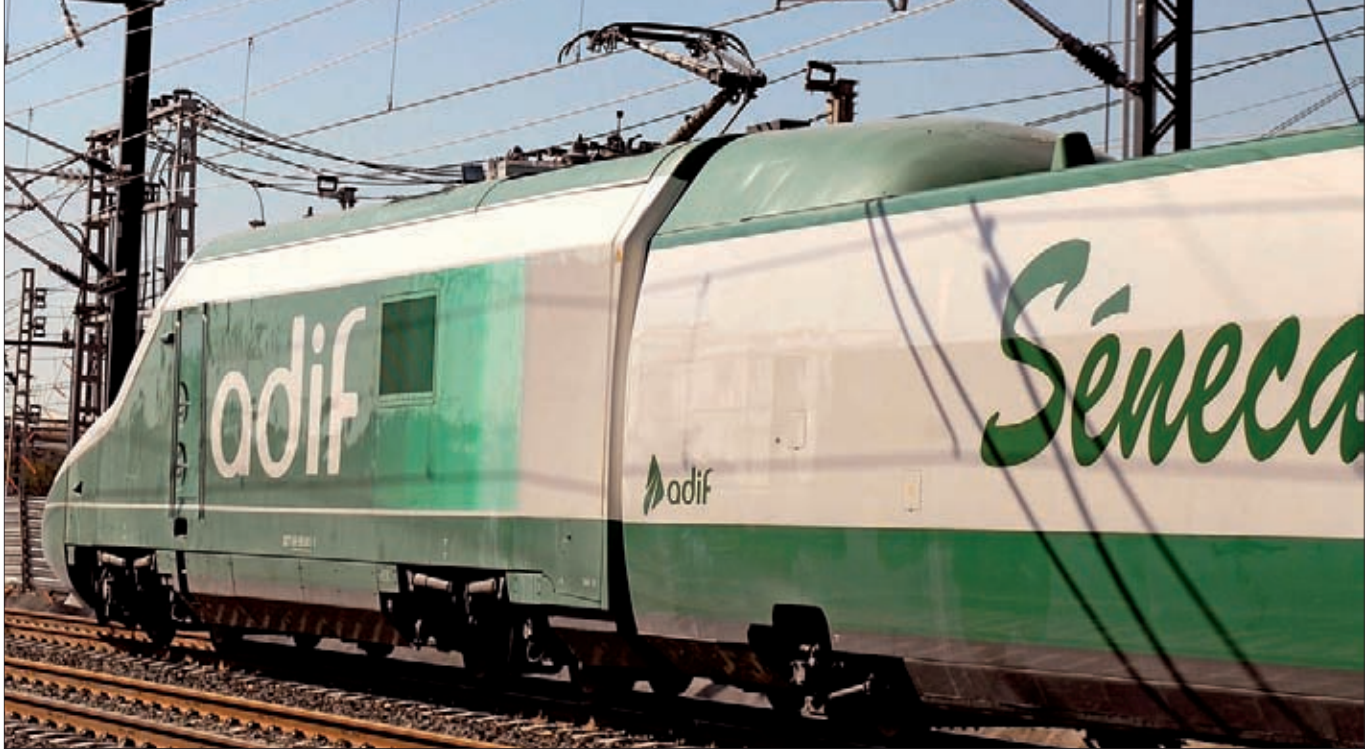
► El anillo ferroviario de Antequera permitirá homologar los nuevos des arrollos de alta velocidad. En la foto, tren laboratorio de Adif.
