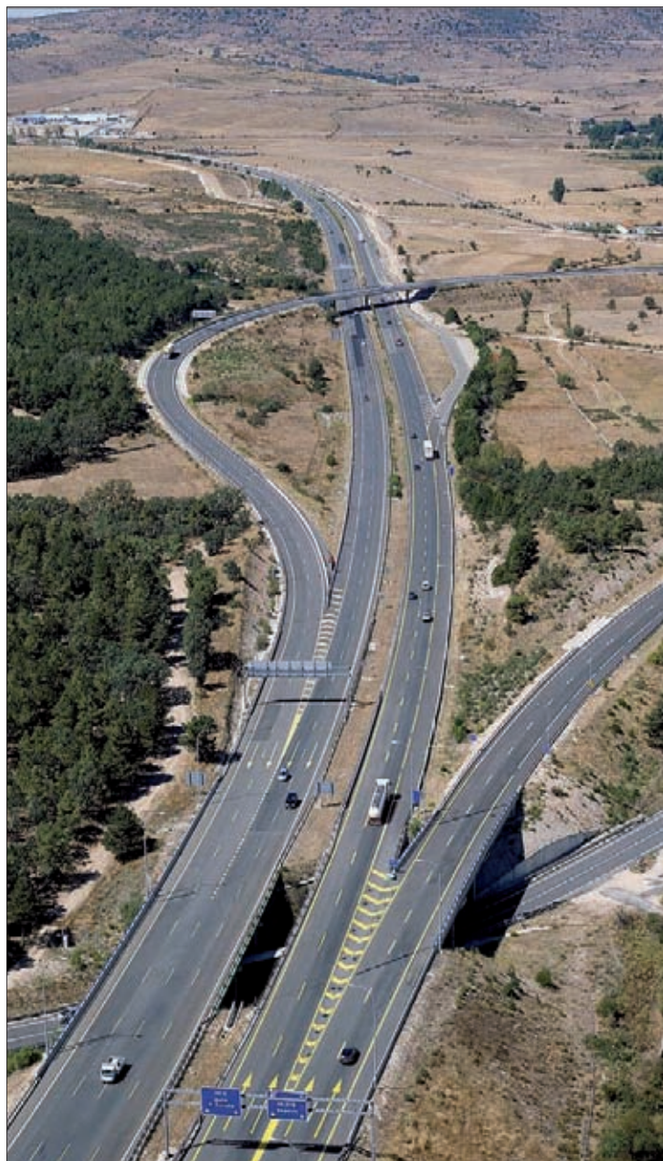
► Vista aérea del pk 61, en la conexión de la AP-6 con la AP-61, antes de la actuación (con dos carriles por sentido) y después (con tres carriles).
