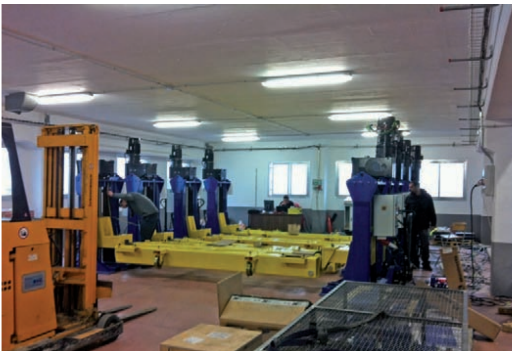
► Instalación del banco de ensayos de descarga de rueda.
