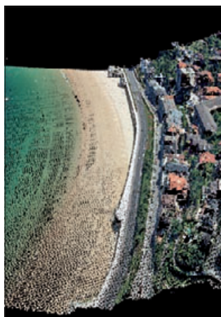
► Imagen de nube de puntos con láser para la obtención de modelo digital del terreno.
