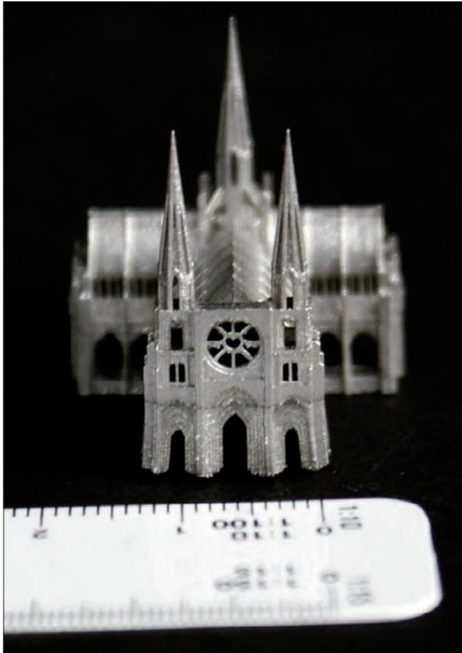
► Catedral impresa por sintetizador láser de polvo de cromo en alta precisión.
