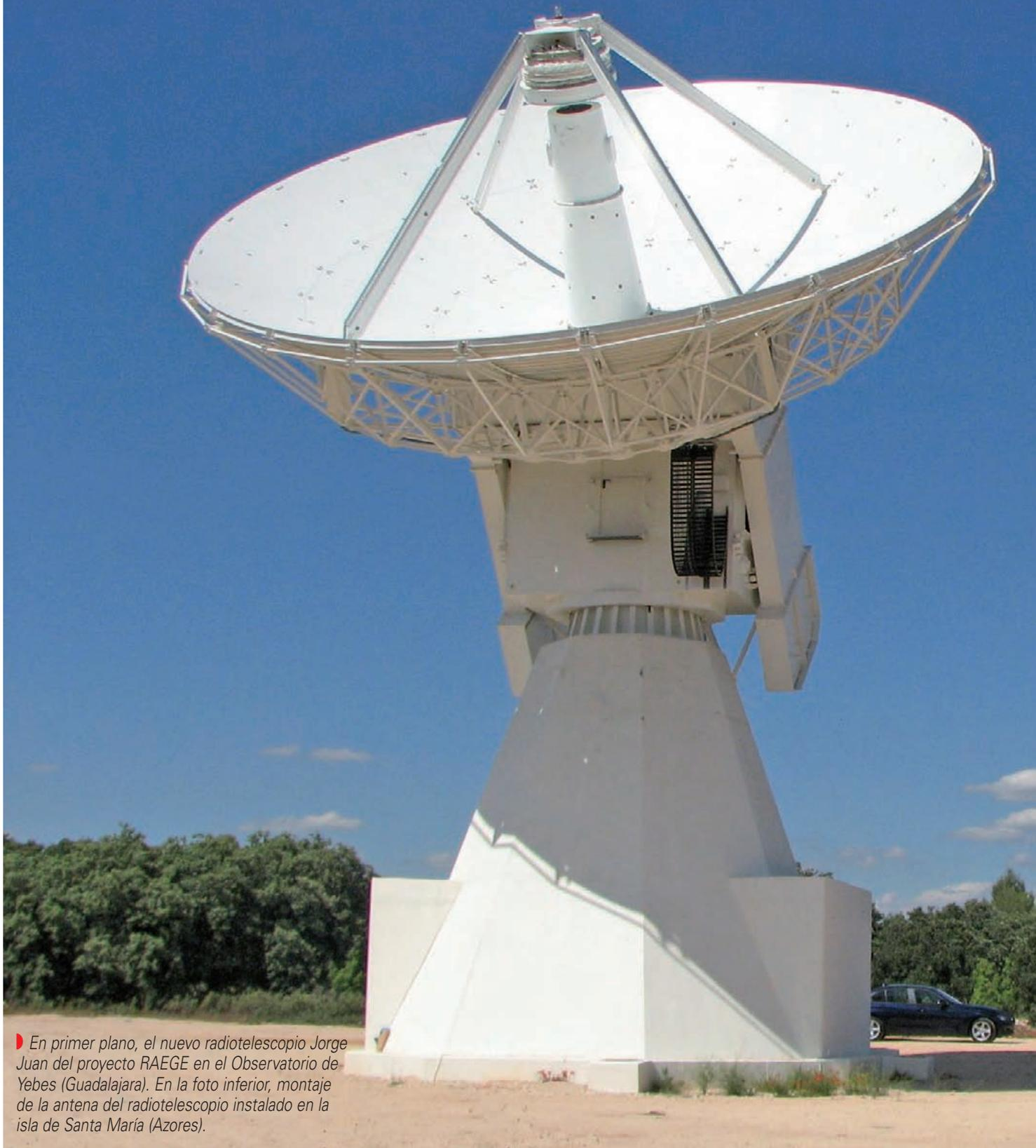
▶ En primer plano, el nuevo radiotelescopio Jorge Juan del proyecto RAEGE en el Observatorio de Yebes (Guadalajara). En la foto inferior, montaje de la antena del radiotelescopio instalado en la isla de Santa María (Azores).
