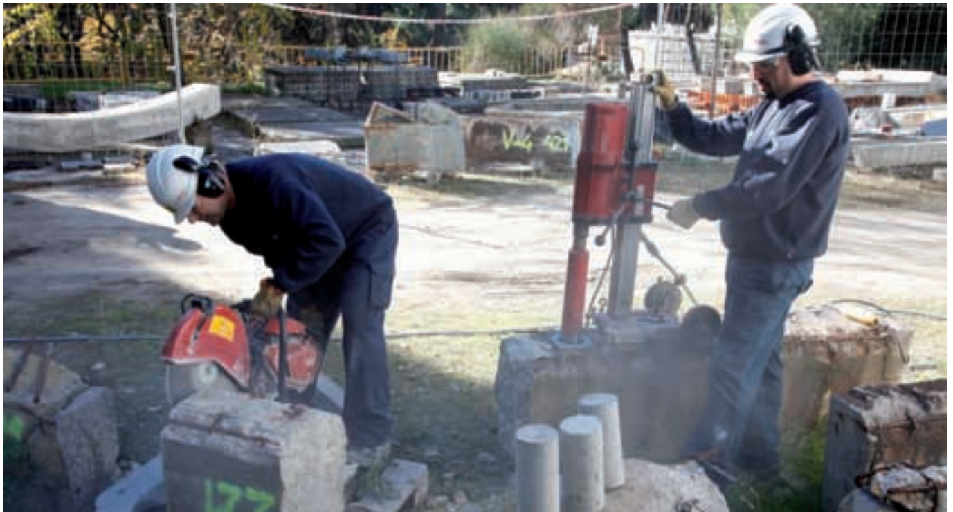
► Técnicos del Instituto efectuando pruebas de control de hormigón. Abajo, equipo de control monitorizado durante un ensayo estructural.
