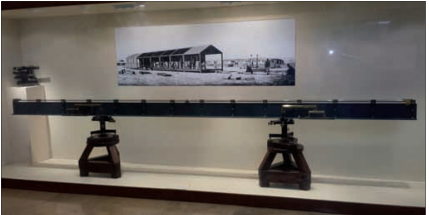
► Regla diseñada por Ibáñez de Ibero y Frutos Saavedra para la medida de bases geodésicas, conservada en el Observatorio Astronómico Nacional. Debajo, la regla en un dibujo de época.
