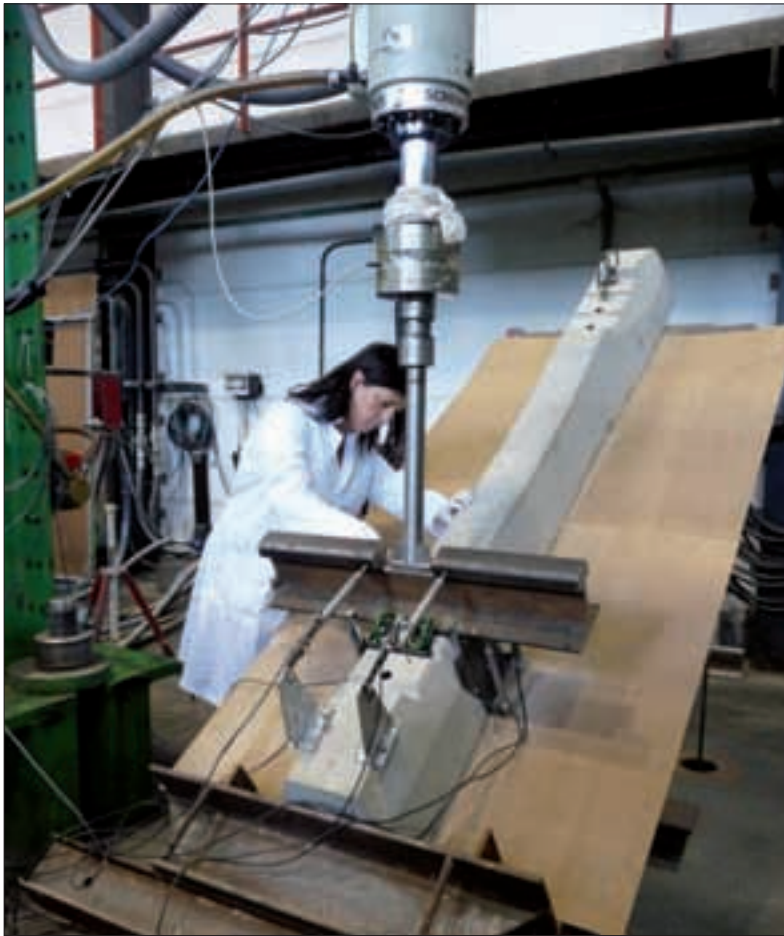
► Pruebas de control de calidad en traviesas del AVE
