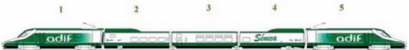
► 1. Coche de bogies con cabina de conducción (CEBYC). 2. Coche para equipos auxiliares y asientos. 3. Coche laboratorio. 4. Coche laboratorio. 5. Cabeza tractora
