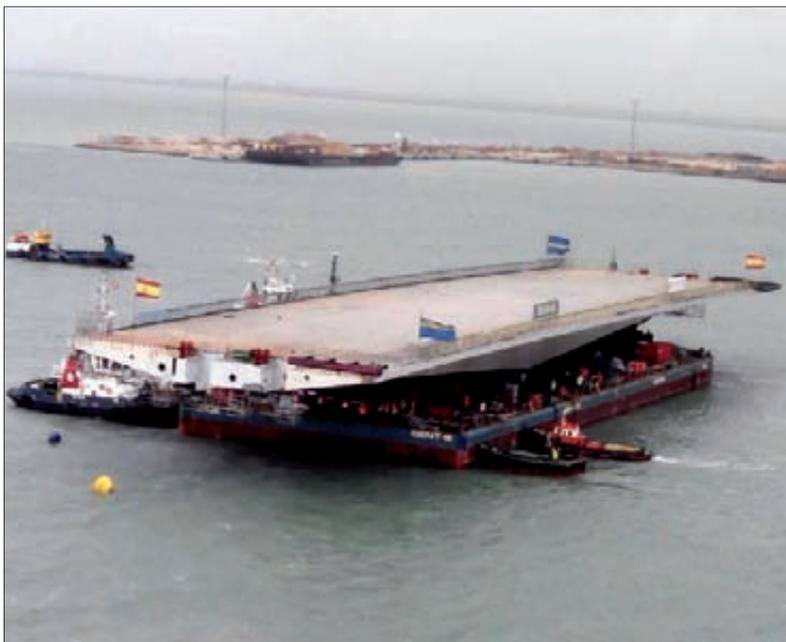
► Transporte del tramo desmontable a bordo de una pontona.
