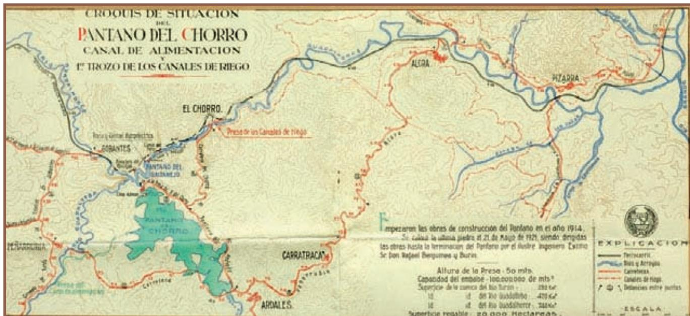
en la margen derecha de las agrestes paredes del tajo, por las que discurría un canal forzado que transportaba el agua 3.280 m de norte a sur, de los cuales 1.200 m iban a cielo abierto, manteniendo la horizontal mientras iba aumentando la distancia del canal a tierra por el desnivel del río hasta los 98 m en la salida sur del desfiladero, donde se construyó la central hidroeléctrica del Chorro.
