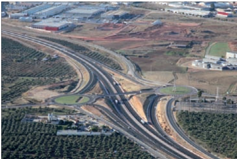
► Enlace de Linares-Jabalquinto, con tipología de diamante. A la dcha., el tronco de la autovía a su paso junto a los restos de la Mina de los Lores.
