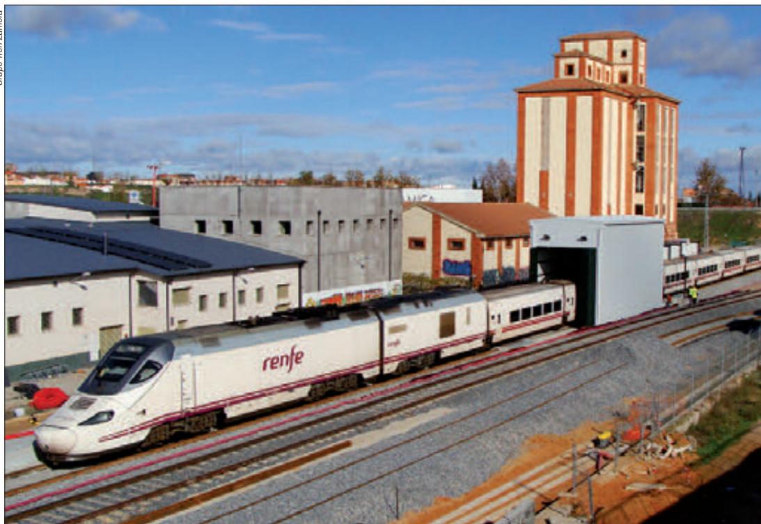
► Un S-730 prueba el cambiador de ancho situado junto a la estación de Zamora.
