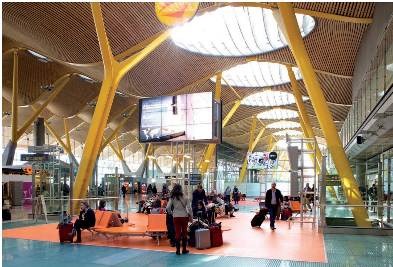
► La luz interior de la terminal es asegurada por amplios lucernarios situados en un techo ondulante de bambú.
