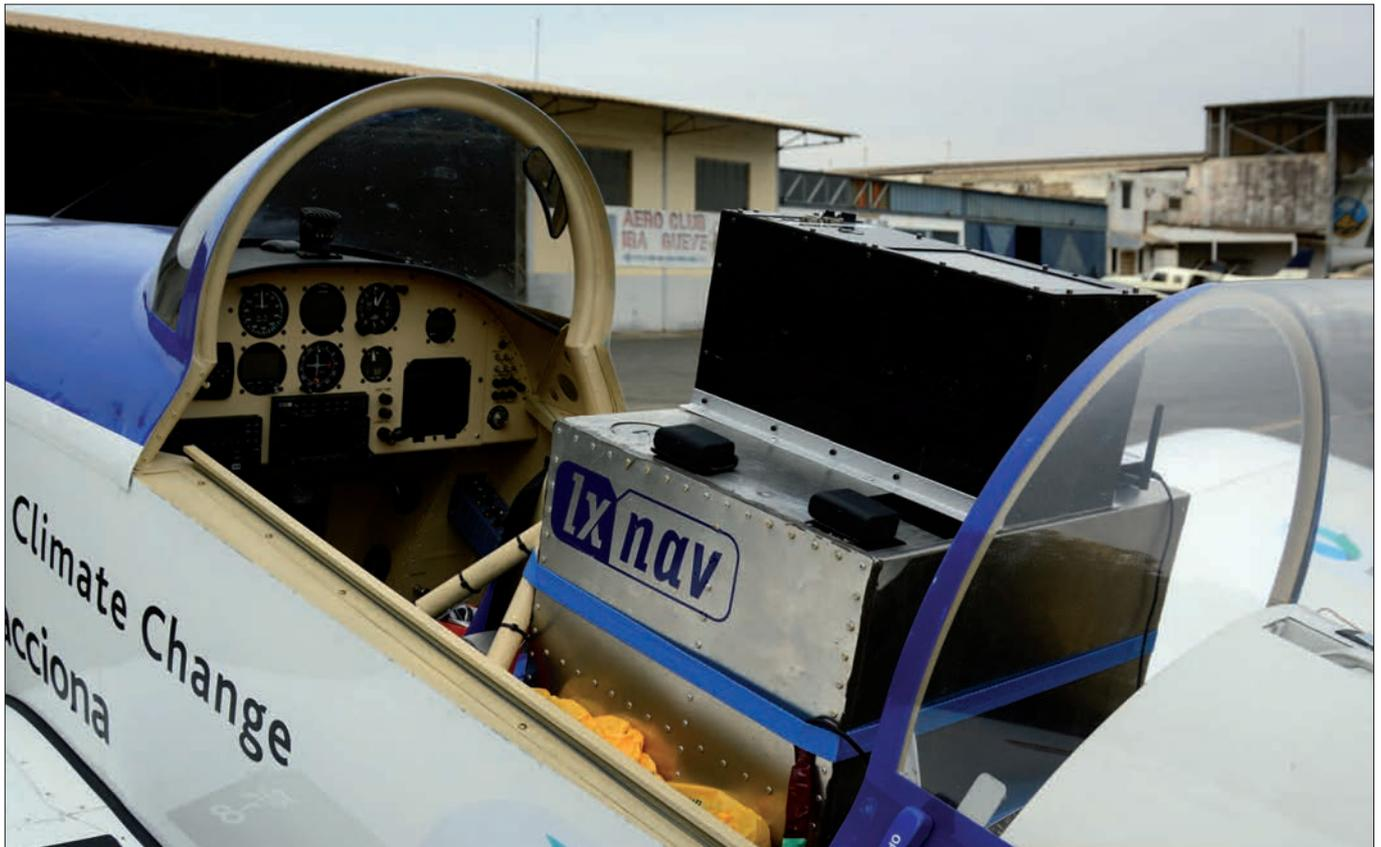
► El aethalómetro embarcado se ha encargado de analizar las concentraciones de carbono negro a una altura media de 1,5 kilómetros.
