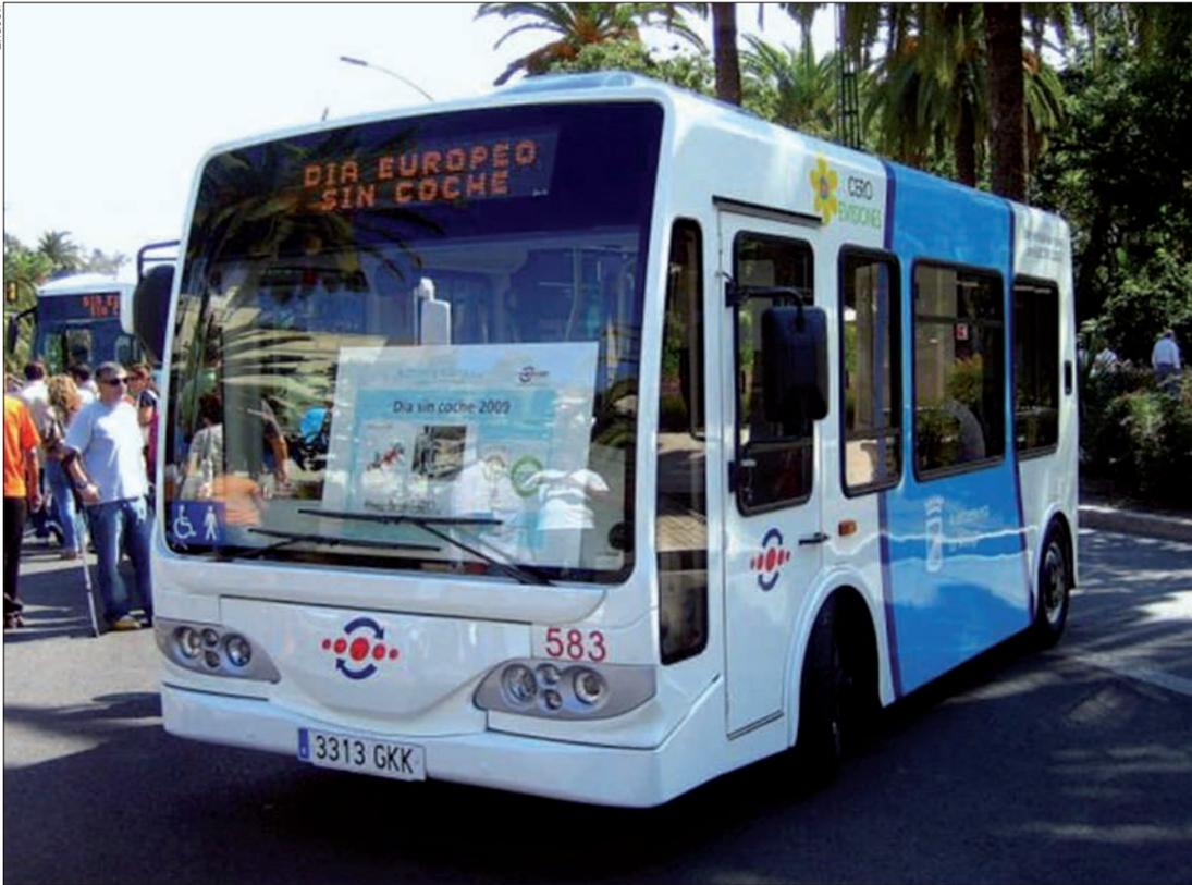
▶ Junto a estas líneas, prototipo de autobús eléctrico del Proyecto Victoria ensayado en Málaga, cuyas baterías se pueden recargar de forma convencional o por inducción durante la marcha o en las paradas (esquema inferior).
