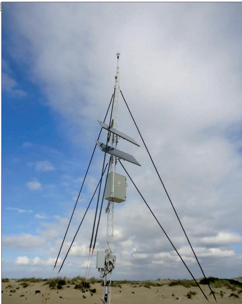
► Arriba, estación meteorológica y sensores de arena en la reserva de Doñana. Derecha, radar de penetración del terreno (GPR), empleado para detectar la contaminación del balasto.
