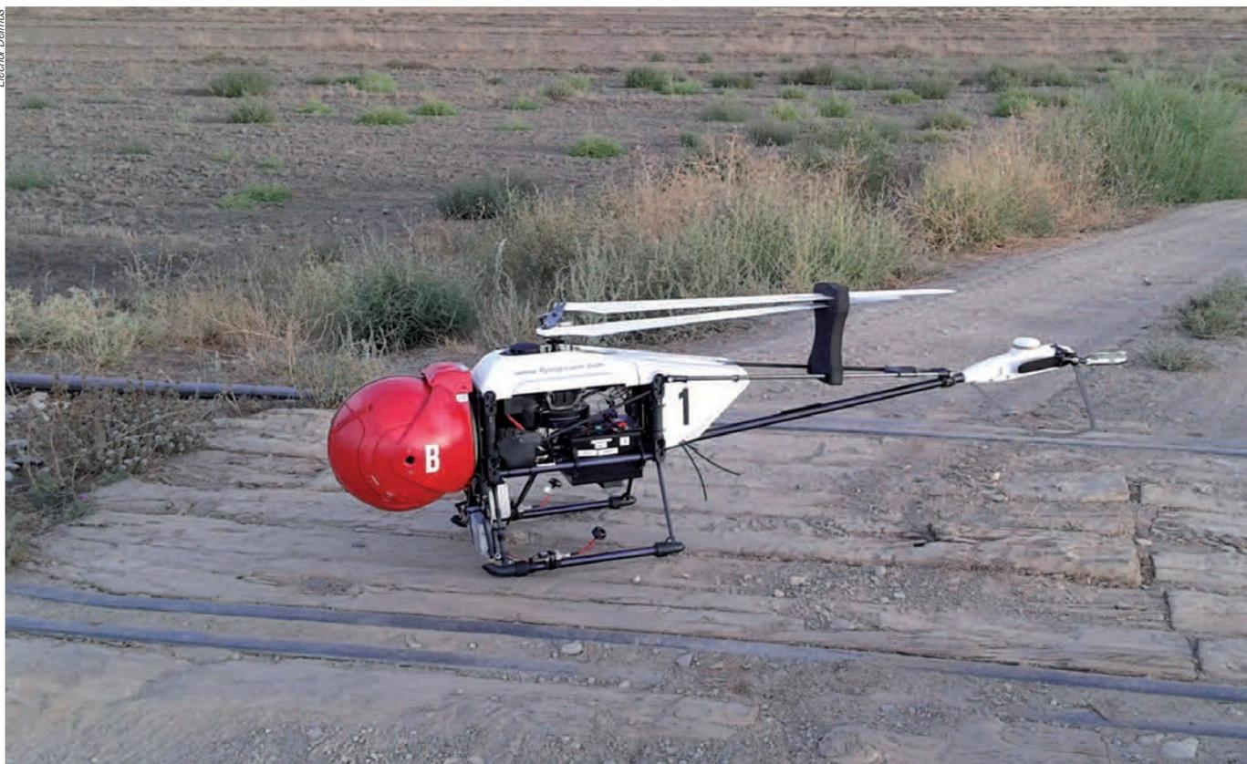
► Vehículo aéreo no tripulado (UAV) empleado en la monitorización de las vías.
