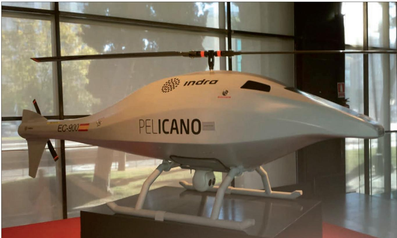
► Prototipo de helicóptero de fibra de carbono de la empresa Indra. Debajo, Drone Halcón Shepherd para control de avifauna en aeropuertos.
