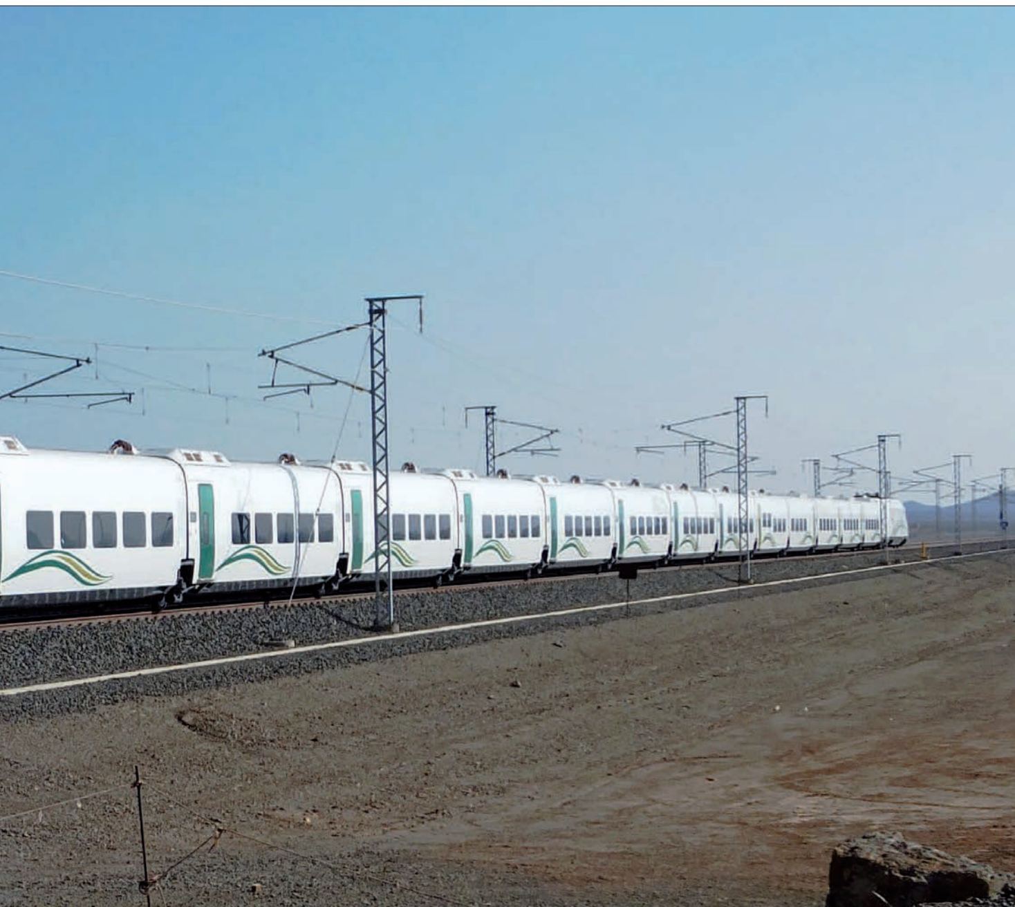
► Composición del Talgo 350 Haramain formada por 13 coches, durante los ensayos.
