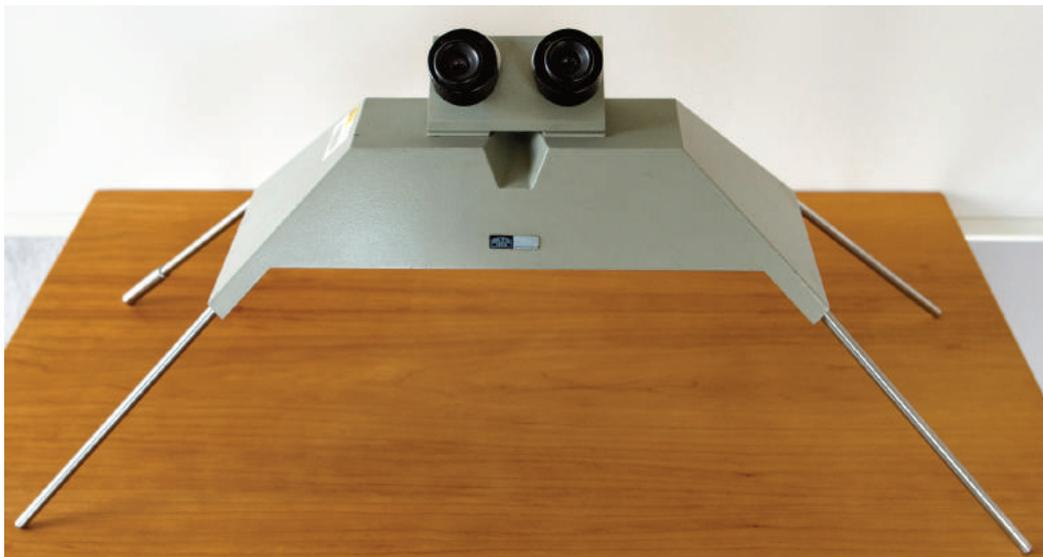
a ambas fotografías (zona de recubrimiento). La profundidad del efecto estereoscópico aumenta con la distancia entre disparos de las fotografías. Además, si se disponen las fotografías en una mesa y se observan en las condiciones expuestas, aparece una impresión tridimensional de la escena.
