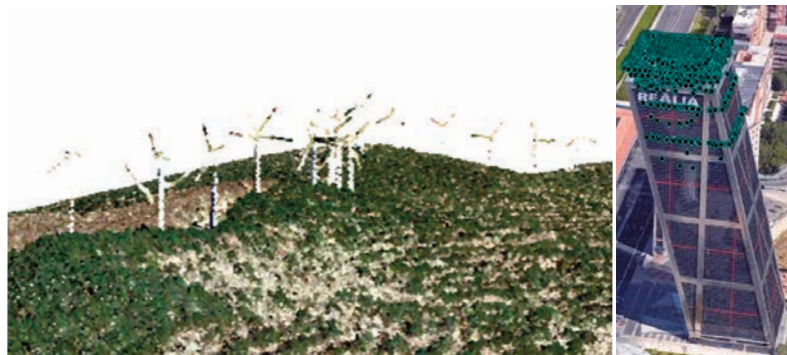
► Nube de puntos LiDAR identificando aerogeneradores.
