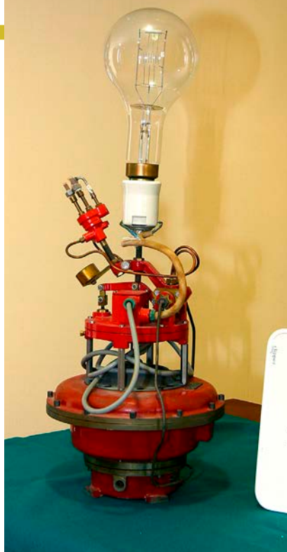
Equipo de iluminación eléctrico con sistema de reserva de gas
