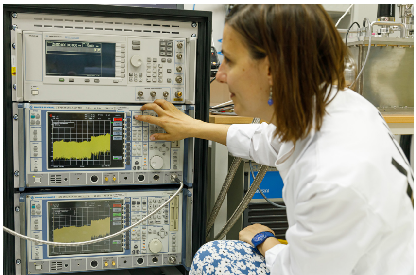
Los laboratorios del Observatorio de Yebes disponen de la instrumentación de medida de radiofrecuencia de precisión para el desarrollo de receptores de radioastronomía como el de Sudáfrica.
