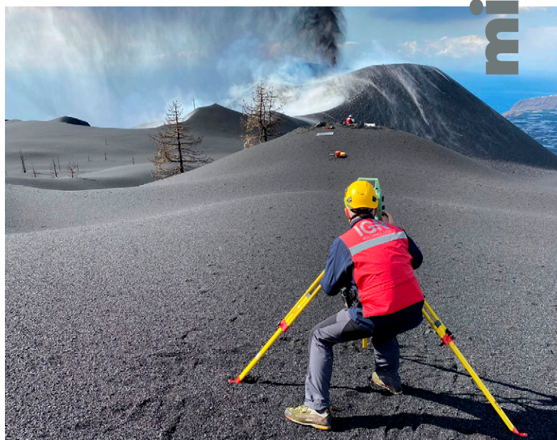
Un equipo del IGN realizando tareas de mantenimiento y calibración de la cámara visual y térmica desplegada al este del centro eruptivo.
