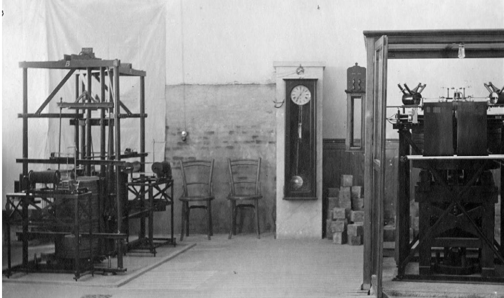
Sala de sismógrafos mecánicos de la Estación Sísmica de Toledo ubicada en los sótanos del edificio de la Diputación Provincial, hacia 1923. A la derecha Sismógrafo Wiechert Astático (instalado en 1910). A la izquierda Sismógrafos Mainka horizontales, las dos componentes (instalado en 1922).
