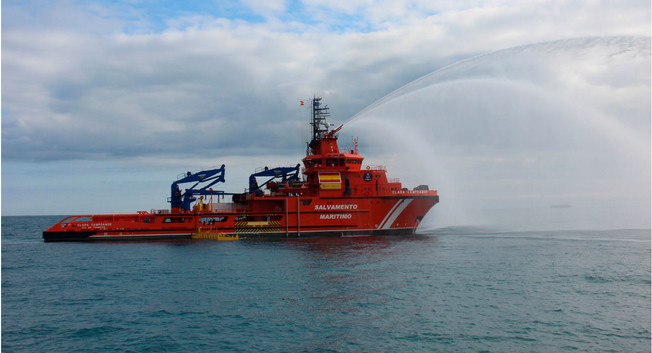
Buque Clara Campoamor realizando labores de mitigación de la nube tóxica mediante FIFI.
