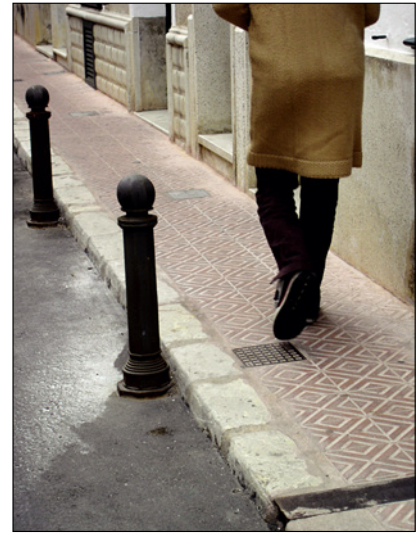
Marmolillo en la calzada para proteger la acera sin reducir la franja de circulación peatonal. Maó (Menorca).
