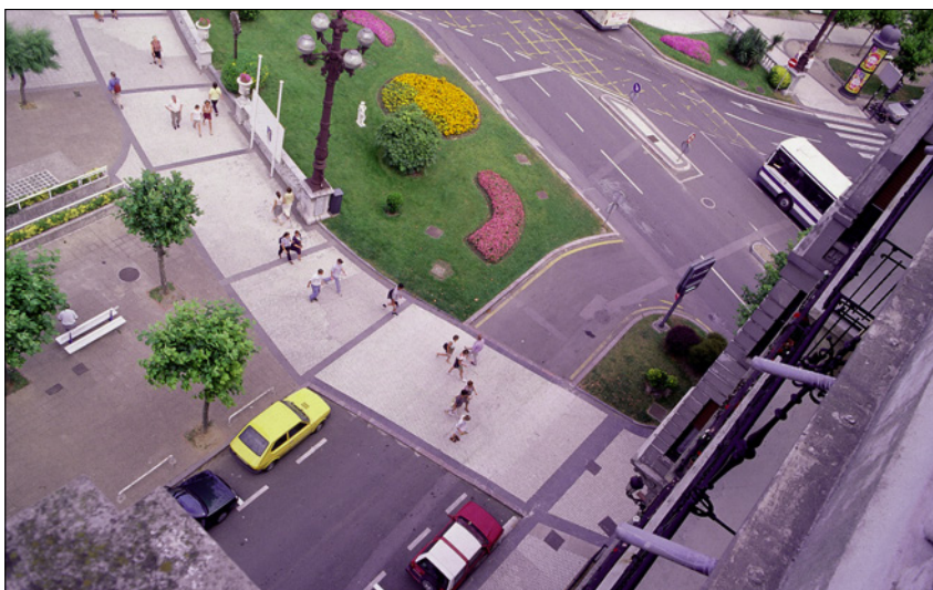
Itinerario peatonal con prioridad de la acera sobre la calzada. Donostia-San Sebastián.
